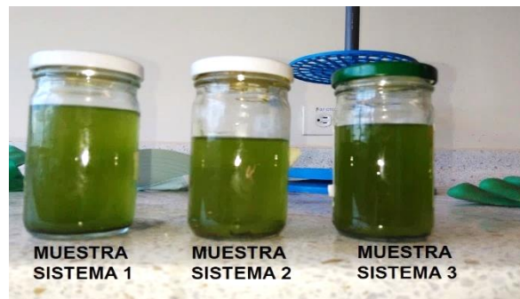
Figura 11. Muestreo de raspado de sustrato en grava de los humedales artificiales 1, 2 y 3. (Autores).
