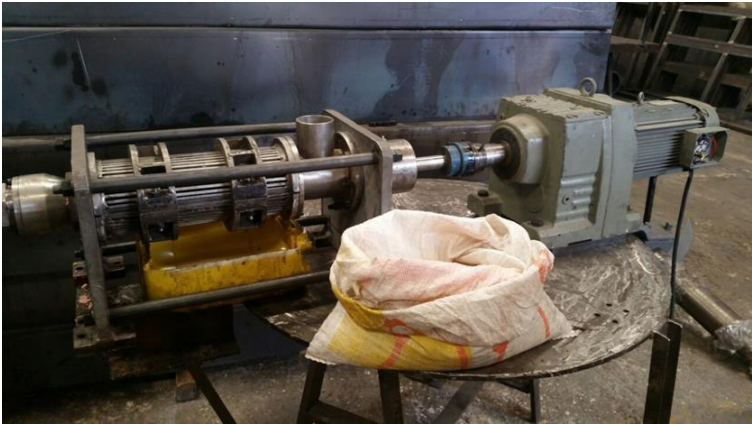
Figura 6. Prototipo prensa de cono para extracción de aceite extra virgen
