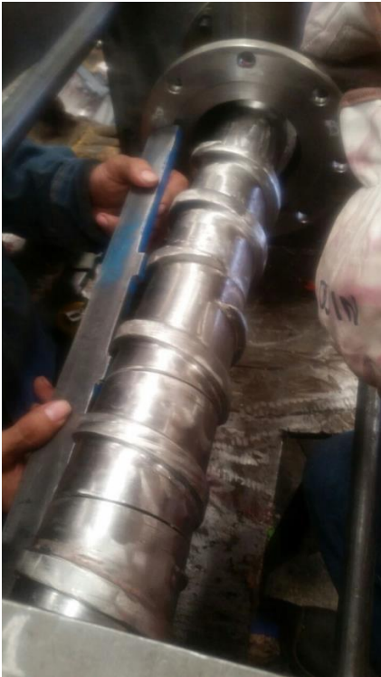
Figura 7. Parte interna prototipo prensa de tornillo para extracción de aceite virgen
