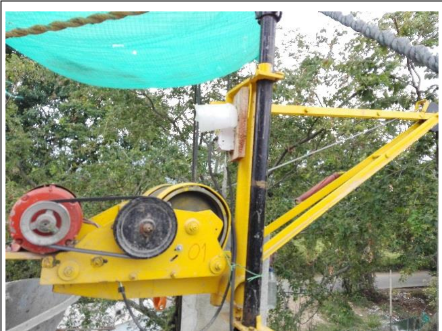
Figura 39. Malacate - Izaje de cargas. Fuente: PROINSAN S.A.S.
