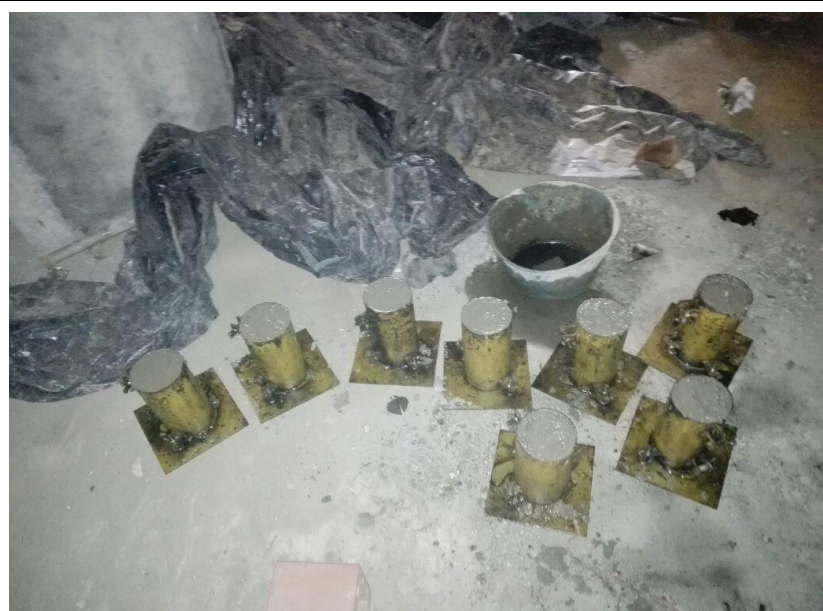
Figura 25. Cilindros de concreto para ensayo de laboratorio. Fuente: PROINSAN S.A.S.
