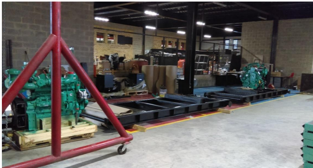
Figura 5. Vista del grupo electrógeno antes de realizar el ensamble al chasis
