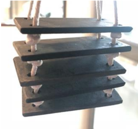
Imagen 10. Evidencia del proceso de amarre realizado con teflón de las láminas entre sí, antes de ser sumergidas al ácido clorhídrico.
