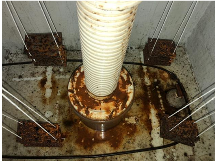
Imagen 18. Láminas al momento de abrir la cámara de niebla salina después de 8 días de ensayo.
