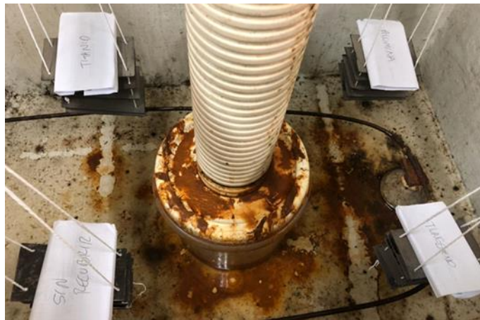
Imagen 16. Montaje de las láminas al interior de la cámara de niebla salina, ordenadas por número y diferenciadas por su tipo de recubrimiento.
