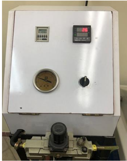
Imagen 17. Tablero del manómetro del compresor y el reloj con el cual se da inicio y final del ensayo.
