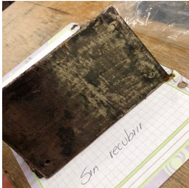
Imagen 15. Ejemplo de cómo quedaron las láminas listas para realizar el ensayo de cámara de niebla salina, evidencia de la lámina sin recubrir.
