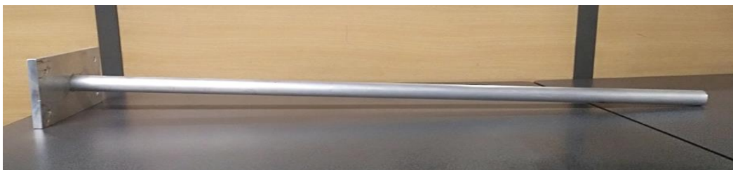
Figura 42. Resultado final de la fabricación de la probeta y placa de ensamble.
