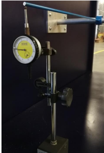
Figura. 11. Comprador de caratula ubicado bajo la barra de medición de desplazamiento vertical
