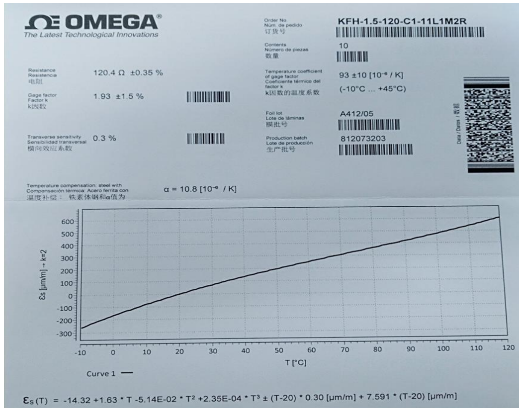
Figura 37 Especificaciones de Galgas KFH-1.5-120-C1-11L1M2R
