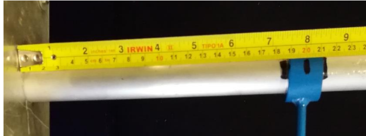
Figura. 9. Posicionamiento de la barra de medición de desplazamiento vertical
