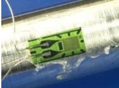
Figura 14. Galga extensiometrica adherida a una probeta
