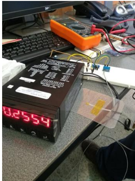
Figura 46. Montaje inicial del sistema de medición de deformaciones en un protoboard
