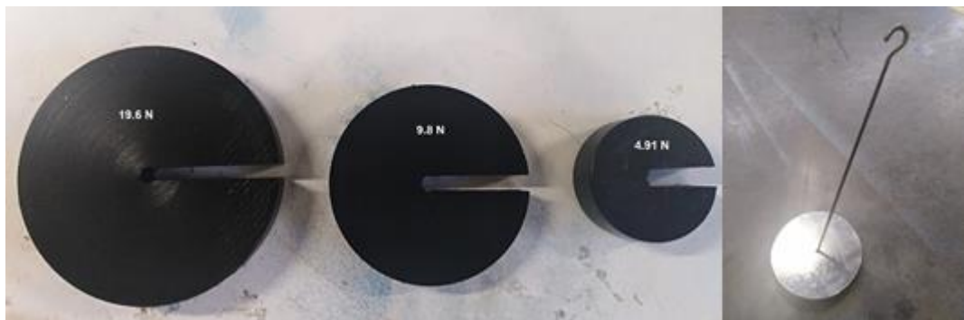
Figura 45. Pesos y porta pesos fabricados
