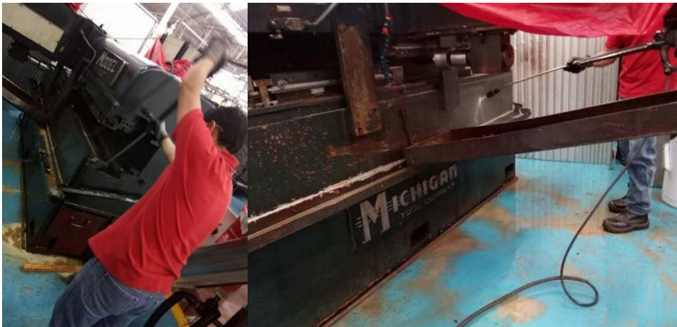
Figura 3, 4, 5 y 6. Limpieza con Hidro-lavadora.
