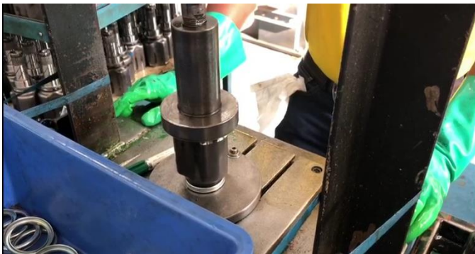
Figura 29 y 30. Tulipa impulsada por el cilindro superior.
