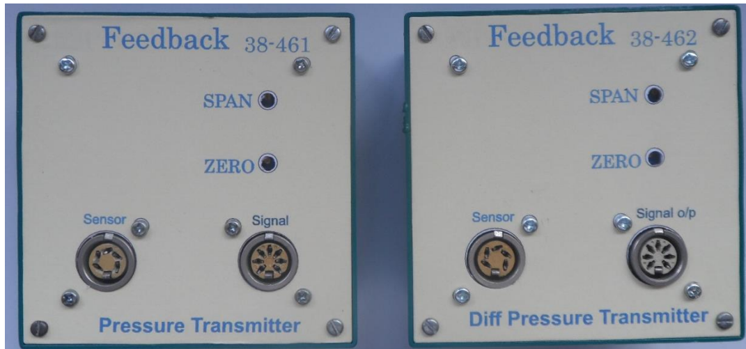
Figura 32. Transmisores de presión finales
