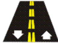
Figura 6. Señal de piso doble y a trazos.
