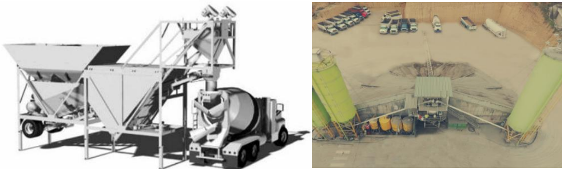
Figura No 9. Planta Dosificadora de Concreto FUENTE: Doplin clasificados
