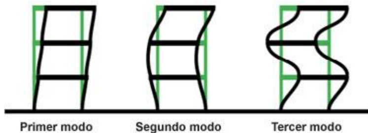
Figura 1: Modos de vibración de un edificio (Arancibia, 2013)
