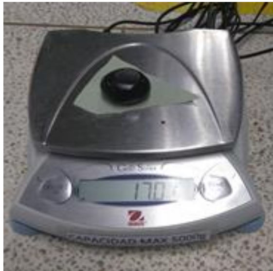
Imagen 14. Ejecución del ensayo de peso específico del material bituminoso.
