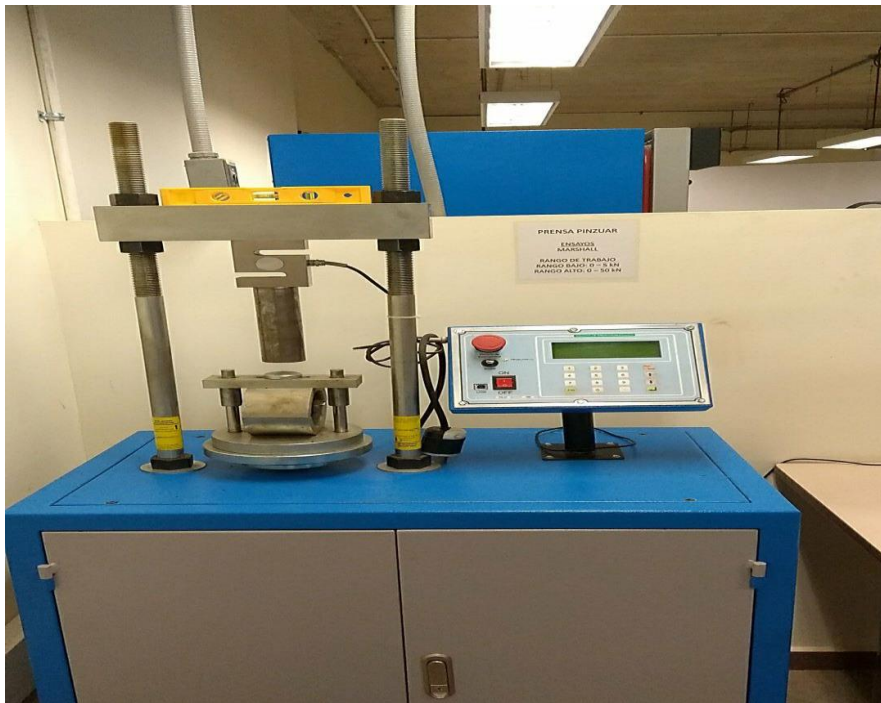
Imagen 20. Prensa ensayo Marshall
