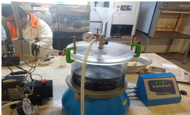
Imagen 24. Proceso de extracción de burbujas de aire de la muestra.
