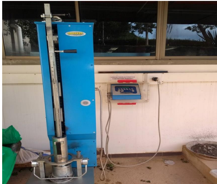
Imagen 18. Máquina de compactación mecánica.
