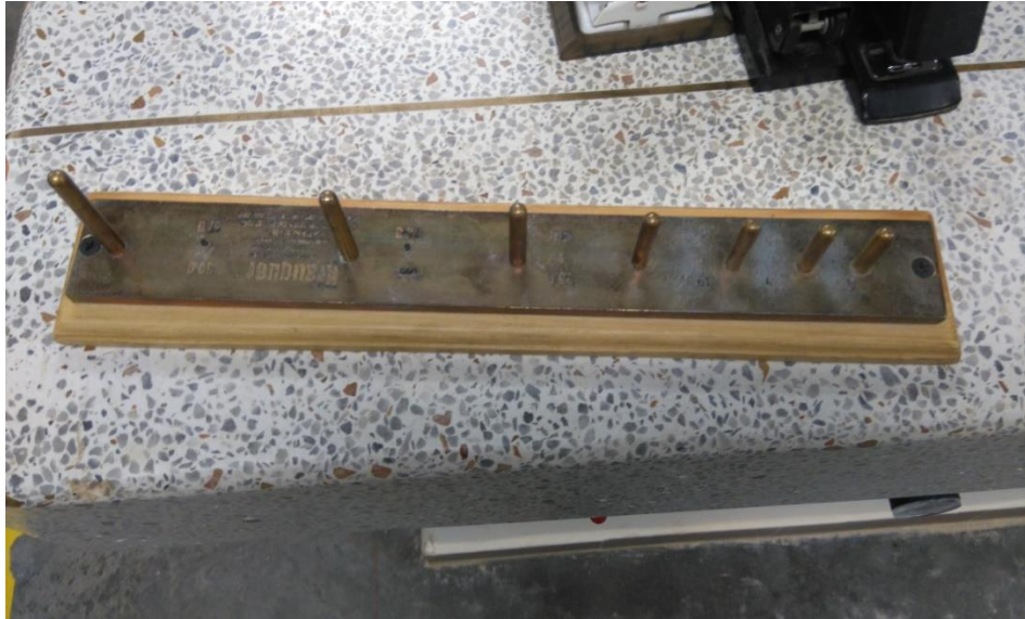
Imagen 5. Calibrador para el ensayo de índice de alargamiento.
