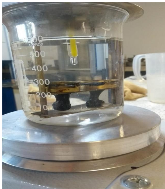
Imagen 11. Punto de ablandamiento del material bituminoso.
