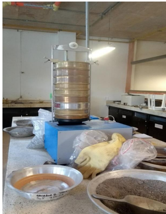
Imagen 1. Tamizado del agregado por medio de la tamizadora mecánica.
