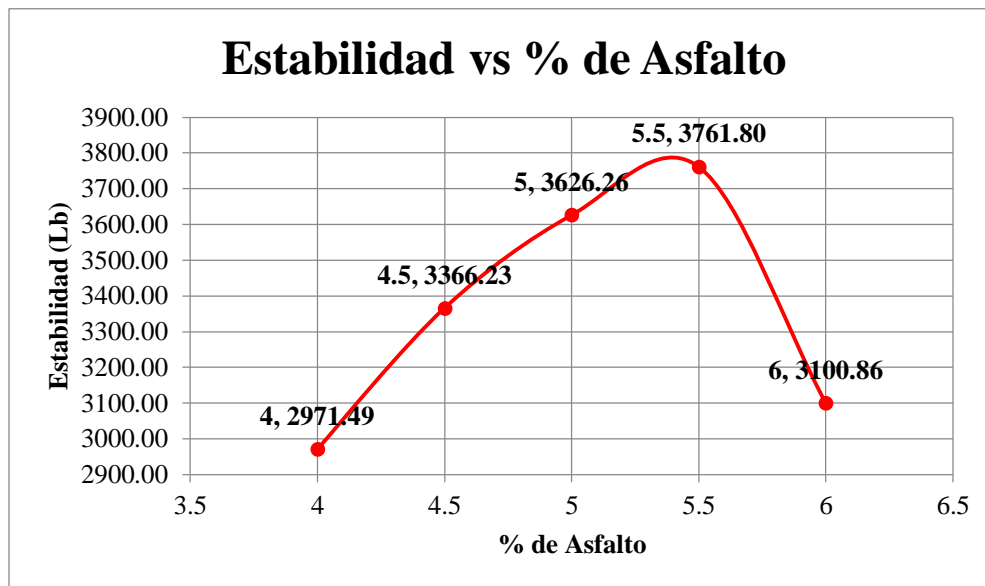
Grafica 5. Comportamiento de la estabilidad vs porcentaje de asfalto.
