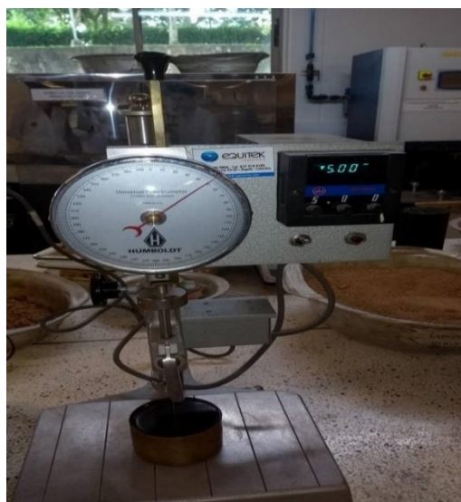
Imagen 8. Equipo para el ensayo de penetración.
