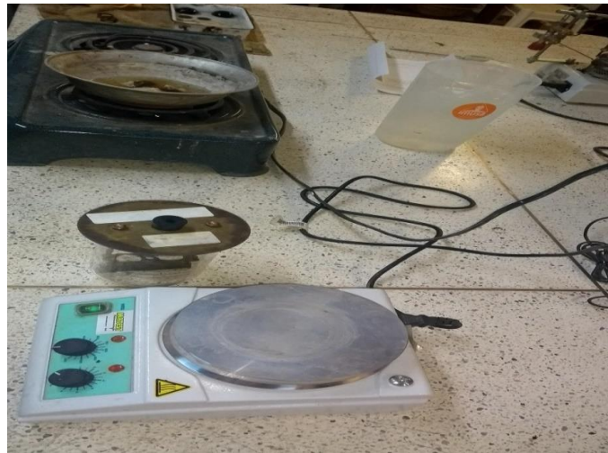
Imagen 10. Equipo para el ensayo de punto de ablandamiento.
