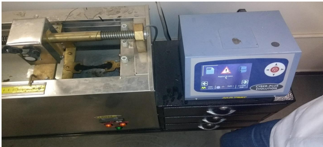
Imagen 12. Máquina para el ensayo de recuperación elástica del material bituminoso.
