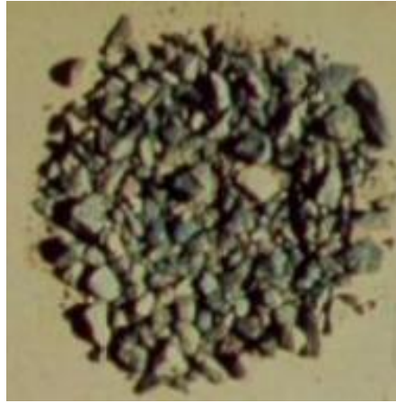
Figura 5. Granulometría de una mezcla discontinua.
