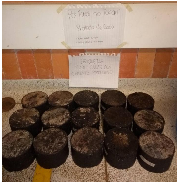
Imagen 25. Briquetas con el porcentaje óptimo de asfalto y modificadas con cemento portland
