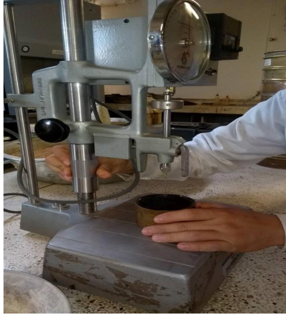
Imagen 9. Penetración del material bituminoso.
