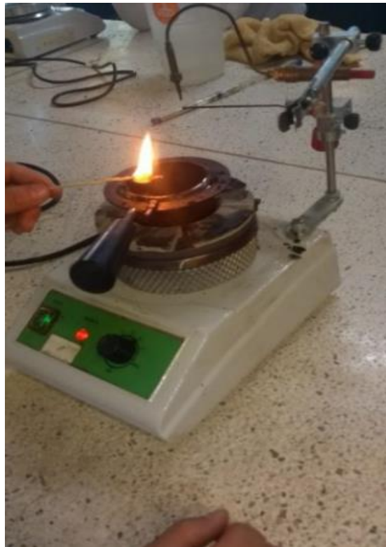
Imagen 13. Punto de inflamación y combustión del cemento asfáltico.
