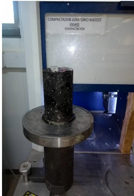
Imagen 27. Extracción de las briquetas del compactador giratorio.
