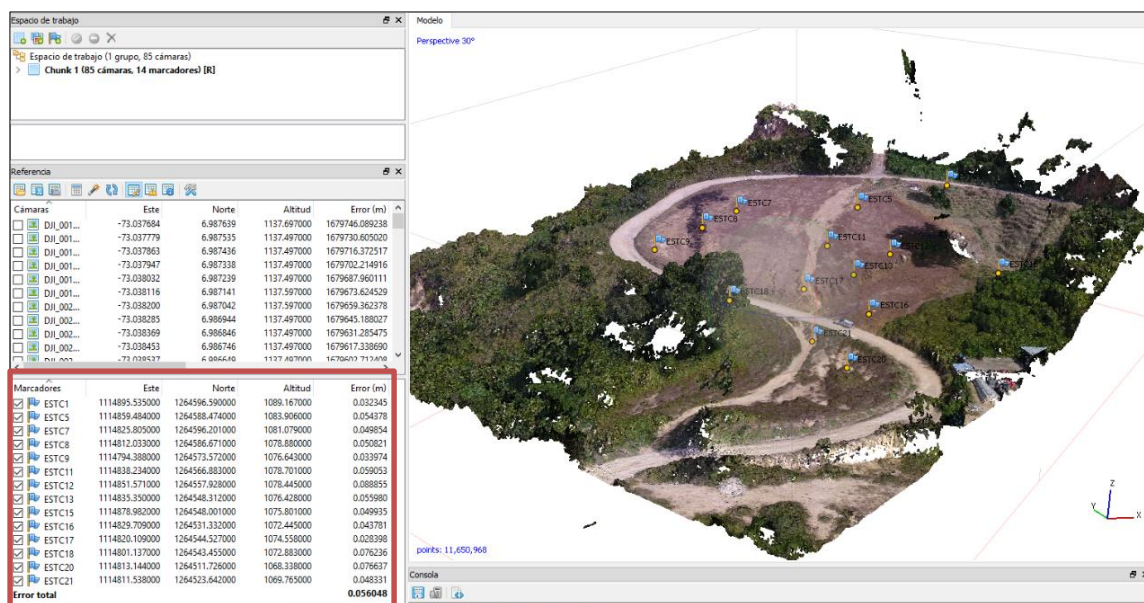
Ilustración 4. Generación de puntos de control a partir del levantamiento topográfico con estación total.
