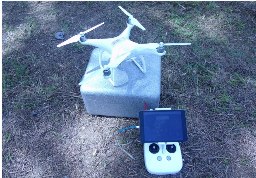
Ilustración 9. VANT DJI phantom 4 utilizado para la toma de fotografías aéreas.
