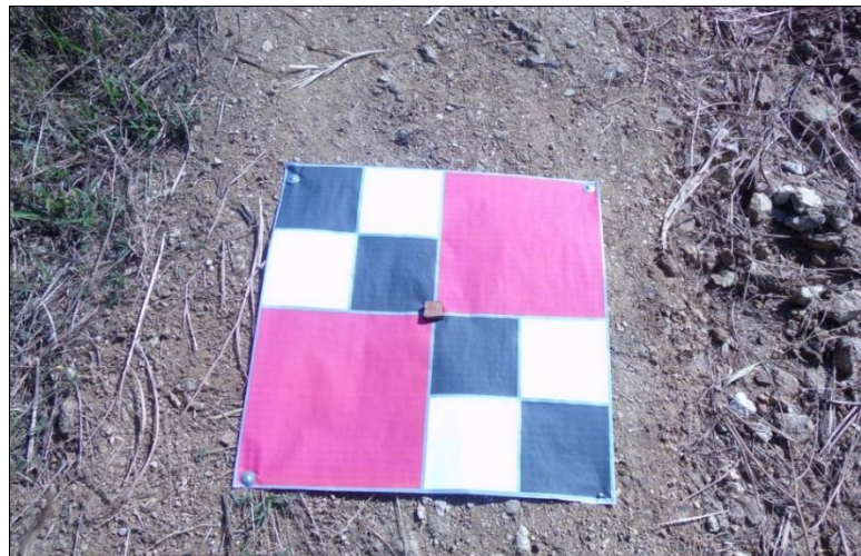
Ilustración 8. Marca de campo para la identificación de puntos de control.
