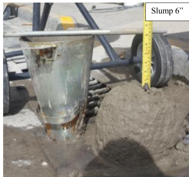
Figura 14. Ensayo de Asentamiento
