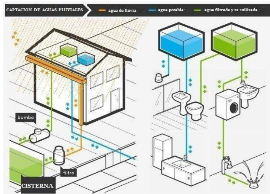
Ilustración 30 Fuente: La vida lucida blog Captación de aguas lluvias
