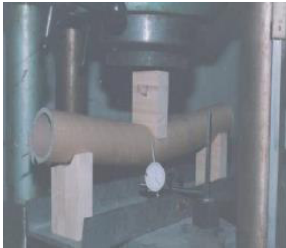
Ilustración 20 Fuente: (Cerón, 2013) Prueba a flexión
