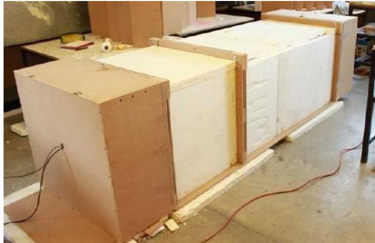
Ilustración 21 Fuente: (Cerón, 2013) Ensayo en el túnel acústico
