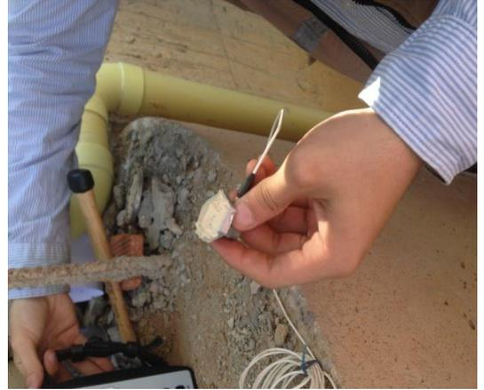
**Figura 29.** Acelerómetro
