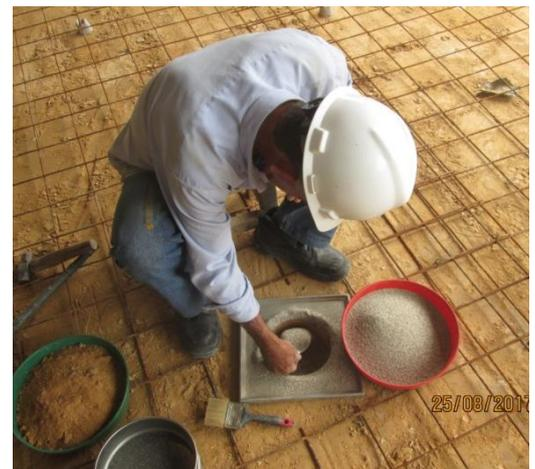
**Figura 26.** Retiro de arena calibrada
