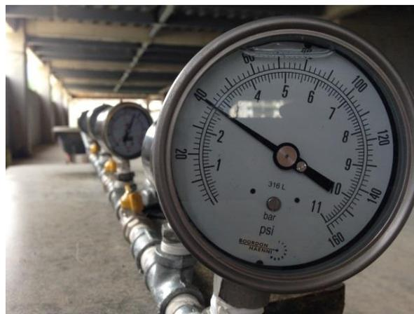
**Figura 12.** Verificación de manómetros
