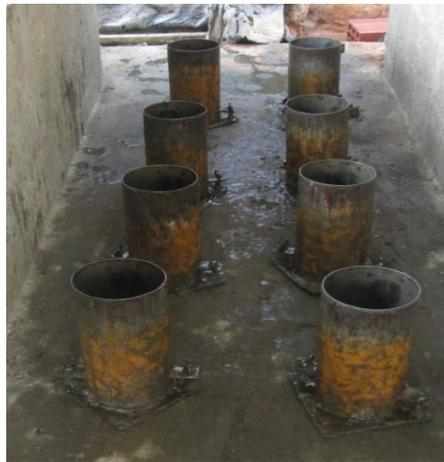
**Figura 9.** Moldes cilíndricos
