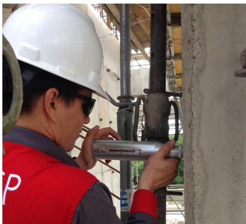
**Figura 35.** Accionamiento del esclerómetro
