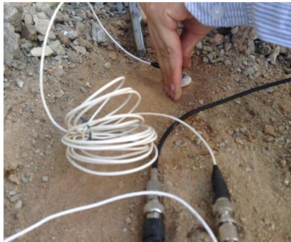
**Figura 30.** Acople sobre el pilote
