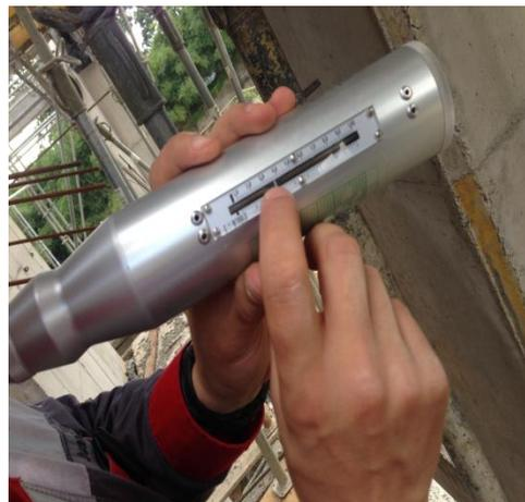
**Figura 36.** Lectura del esclerómetro
