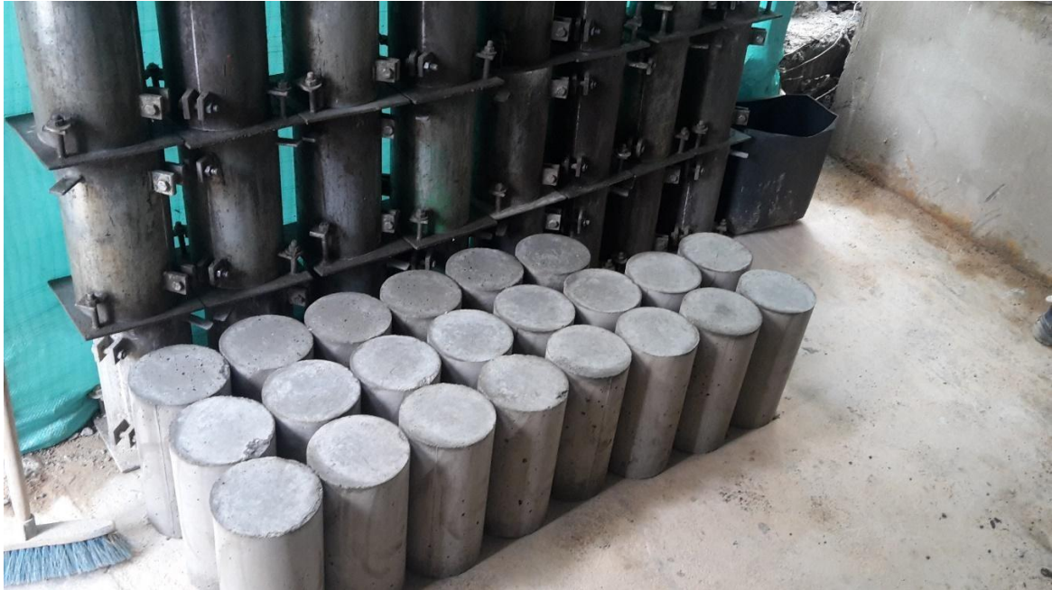
Imagen 7: Desencofrado de cilindros al siguiente día de fundidos
