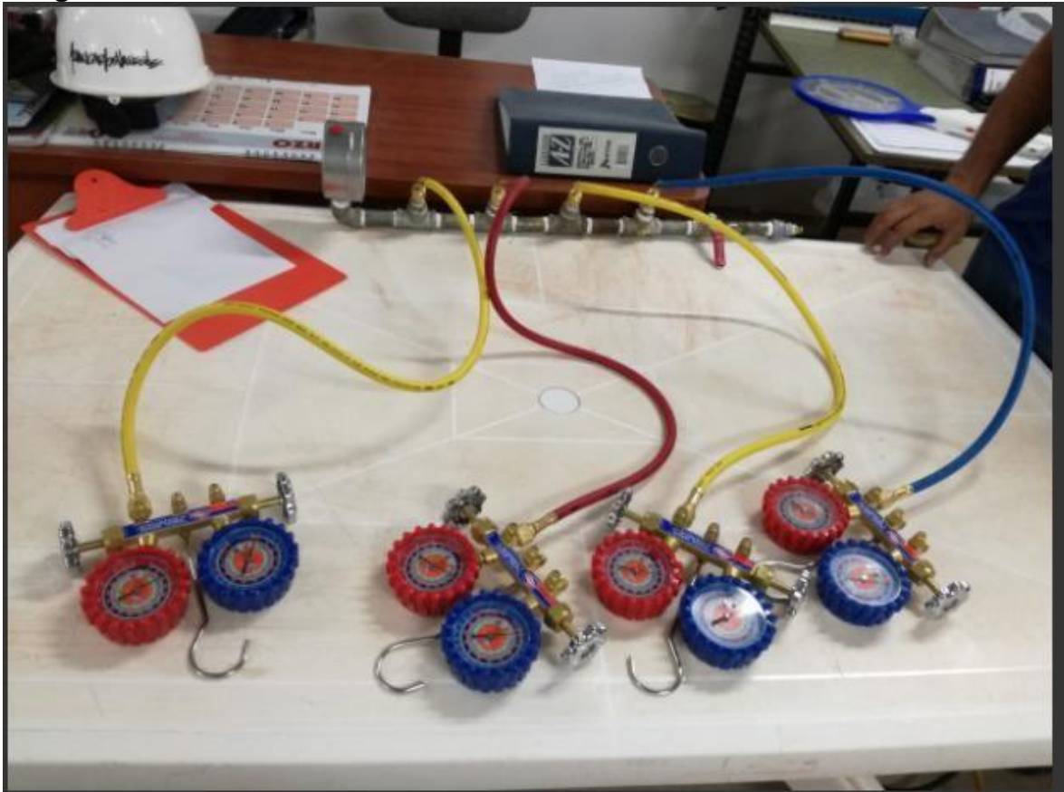
Imagen 1: Verificación de calibración de manómetros.
