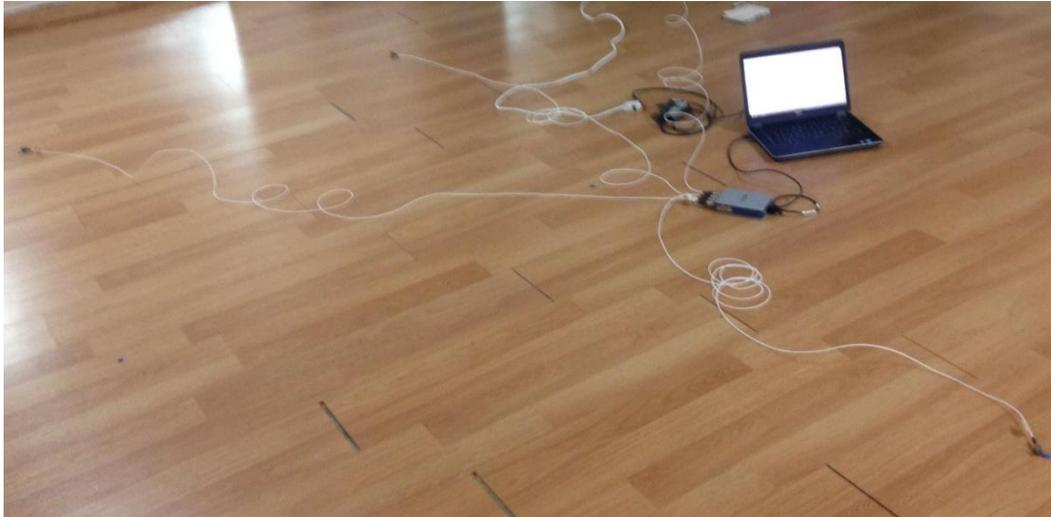
*Imagen 13 Posicionamiento de equipos pruebas de vibración.*
