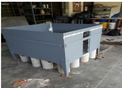
Figura 22: Módulo de acero, apoyado en cilindros de concreto.
