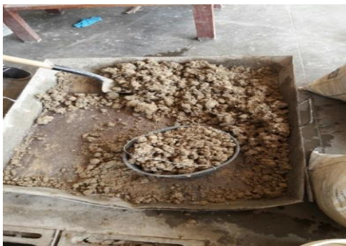
Figura 24: Preparación de la arcilla para su compactación.
