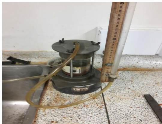
Figura 20: Ensayo de permeabilidad cabeza variable.
