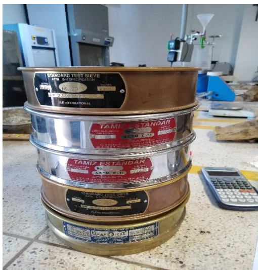
Figura 15: Equipo de tamices para ensayo de granulometría.
