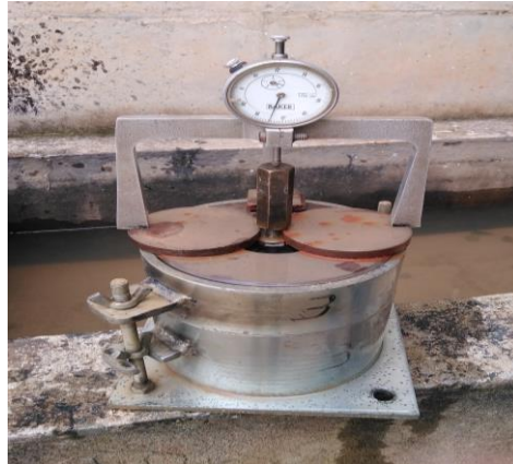
Figura 17: Preparación para el saturado de la muestra de suelo.
