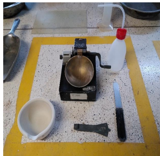
Figura 16: Maquina de Casagrande y vidrio para ensayo de limite líquido y plástico.
