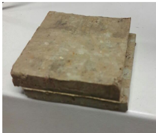
Figura 19: Probeta de suelo después de realizar en ensayo de corte directo.
