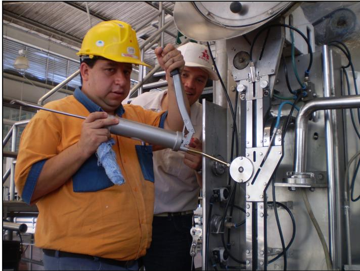
**Figura 35. Tomado de [Autor] “Lubricación de la taponadora”**
