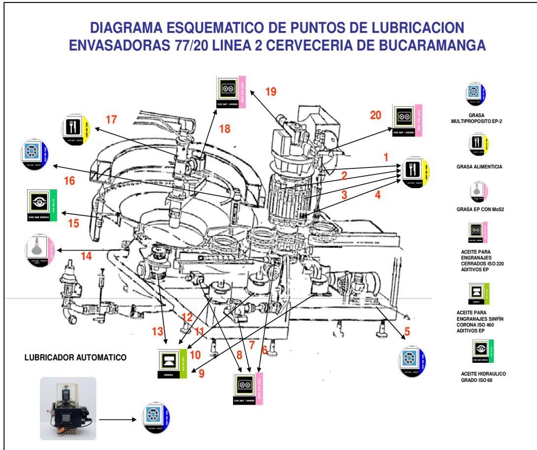
Figura 36. Tomado de [Autor] “Plano de lubricación estándar de la maquina”
