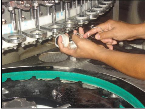
**Figura 42. Tomado de [Autor] “Revisión de tulipas y válvulas de llenado”**
