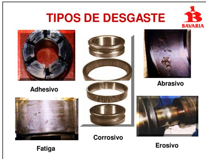
**Figura 32. Tomado de [Autor] “Tipos de desgaste”**
