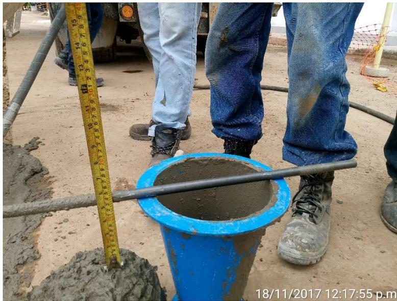
Figura 20. Ensayo de asentamiento del concreto.
