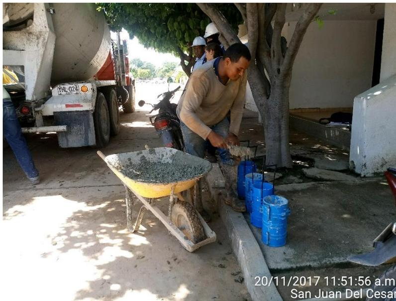
Figura 19. Cilindros para ensayo de resistencia a la compresión
