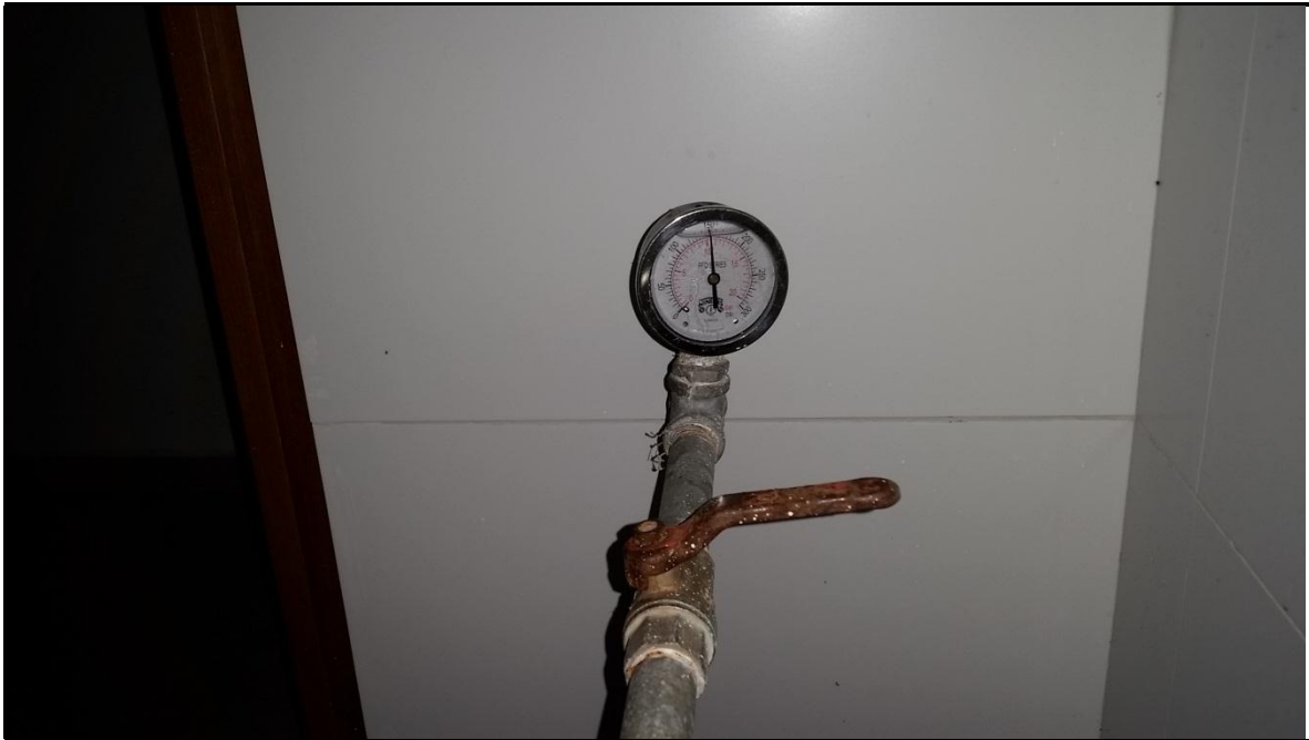
Imagen 12 Prueba de presión hidrostática a 150 psi
