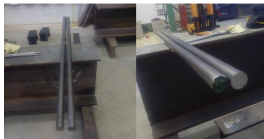
Figura 49. Pasadores utilizados en las articulaciones del marco de carga.
