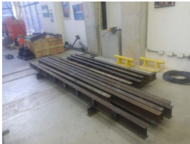
Figura 46. Perfiles metálicos IPE 140-A36.
