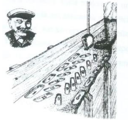
Figura 14 Orden de los golpes realizados al compactar una capa de tierra (Gernot, 2001)
