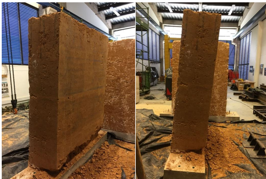
Figura 62. Volcamiento y demolición del muro.
