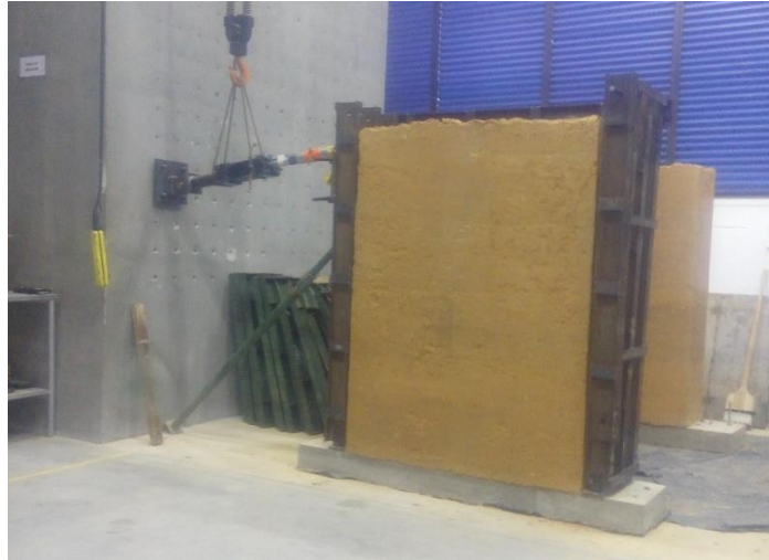
Figura 70. Montaje del marco de carga.
