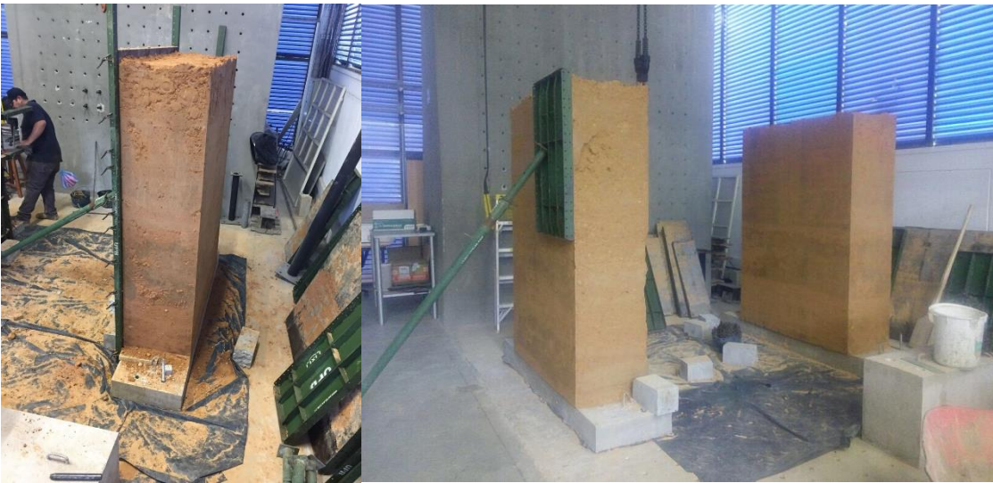
Figura 60. Muros Desencofrados y terminados.
