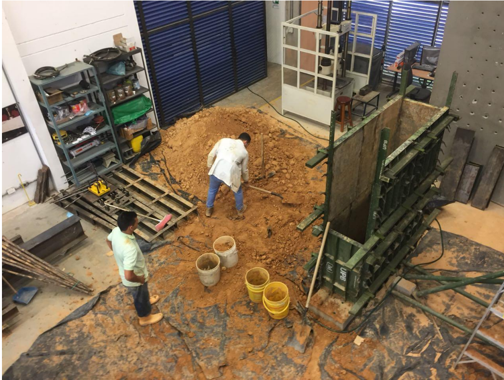
Figura 66. Preparación del material en los muros C y D.
