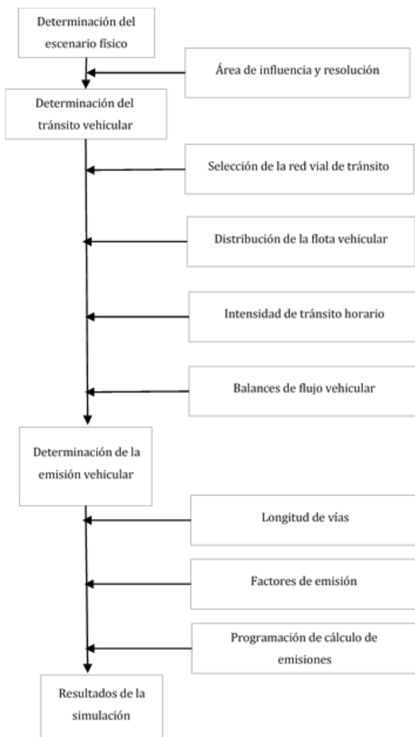
Figura 2. Metodología para la desagregación y simulación de emisiones vehiculares.
