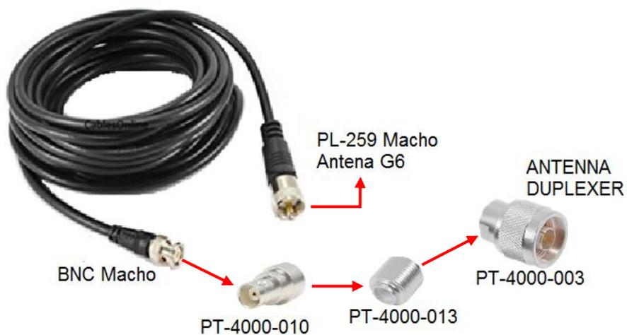
Ilustración 79. Conexión del cable a la antena G6.
