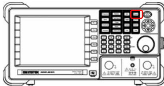
Ilustración 104. Analizador de espectro GSP 830.
