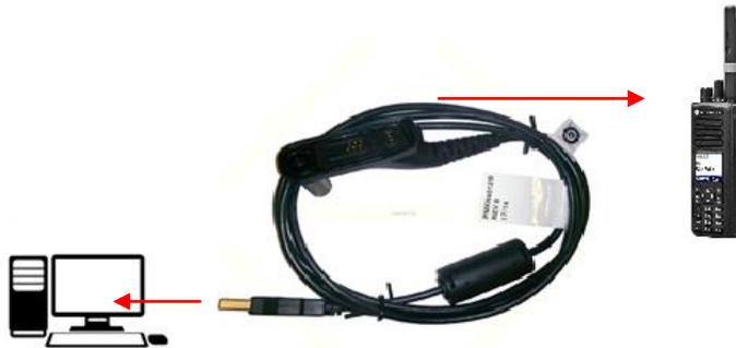
*Ilustración 133. Conexión cable PMKN4012B.*
