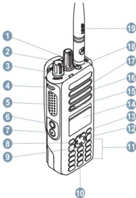
Ilustración 15. Partes radio DGP8550.
