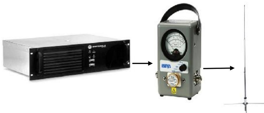
*Ilustración 9. Diagrama de conexión repetidor-antena G6.*
