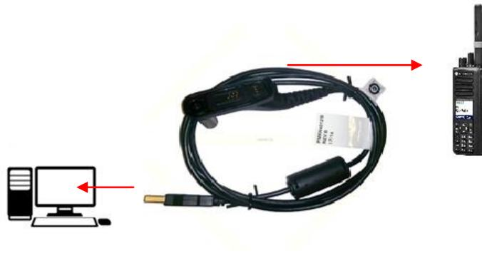
*Ilustración 84. Conexión cable PMKN4012B.*
