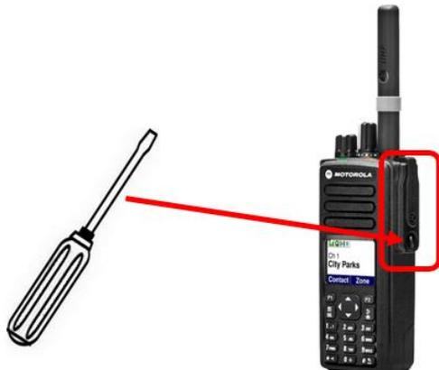
Ilustración 16. Remover escudo del conector universal.
