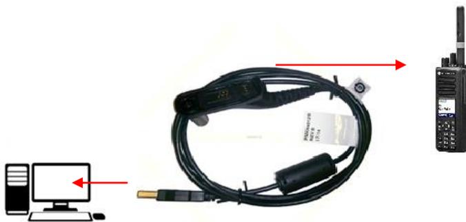
Ilustración 17. Conexión cable PMKN4012B.
