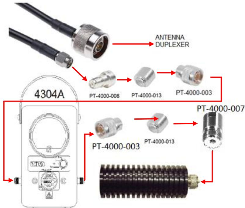
Ilustración 171. Conexión del vatímetro con carga fantasma.
