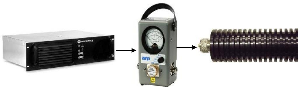
*Ilustración 8. Diagrama de conexión repetidor-antena fantasma.*
