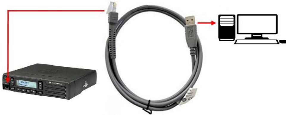
Ilustración 148. Conexión cable de configuración PMKN4147A.
