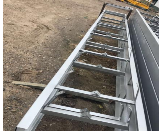
Figura No 33 : Bases para banda de cargue y descargue.
