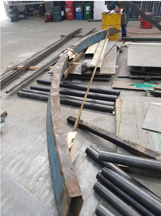
Imagen 9. Fabricación de la escalera en planta
