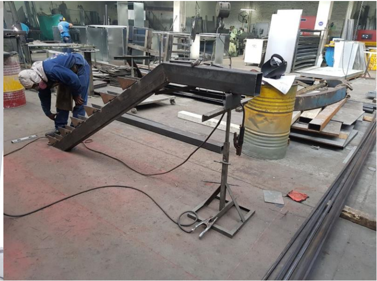
imagen 4. Fabricación primer tramo en planta
