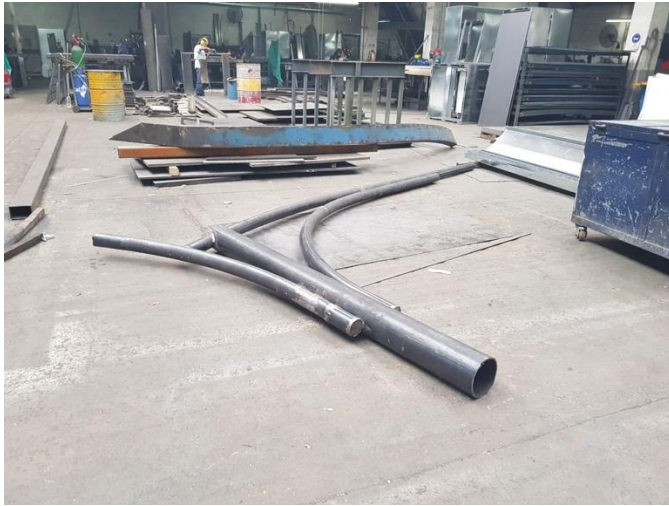
Imagen 13. Fabricación de pórticos En la planta.
