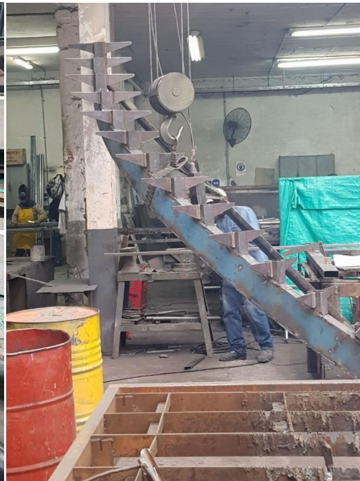
Imagen 9. Fabricación de la escalera en planta
