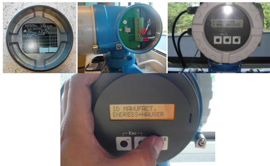
Figura 26: Instalación de las cubiertas [5]
