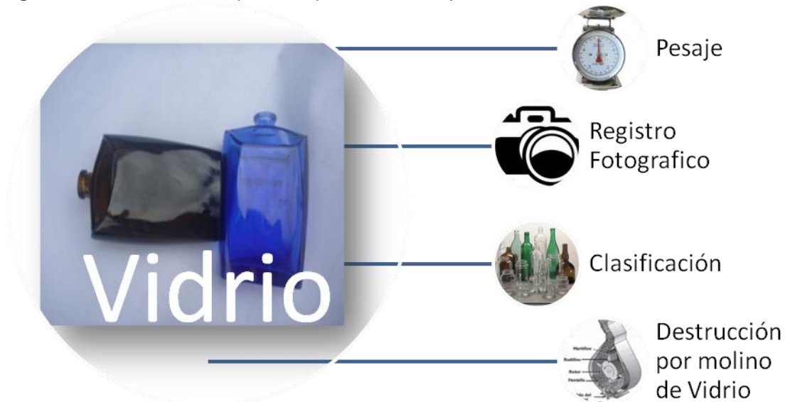
Figura 7. Proceso realizado por la empresa de reciclaje del vidrio.
