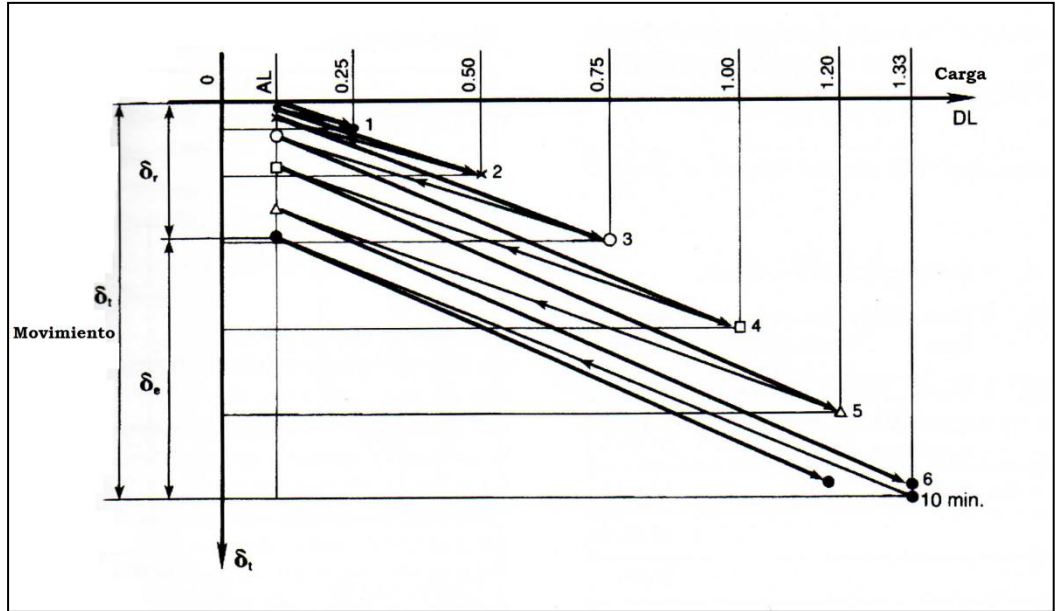
Figura 3.a. Datos obtenidos en el ensayo de desempeño. Tomado de: PTI. Recommendations for prestressed rock and soil Anchor. USA: ADSC, 2004. p73 (PTI-DC 35)
