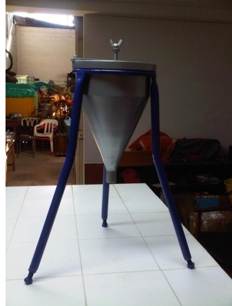
Figura 11. Cono de Marsh, ensayo de fluidez
