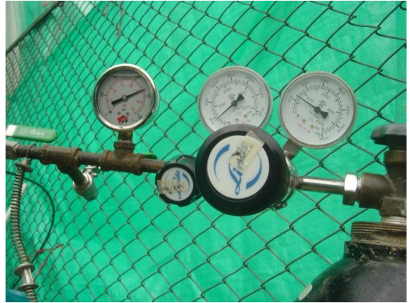
Figura 3. Válvula de regulación de presión de inflado del obturador.
