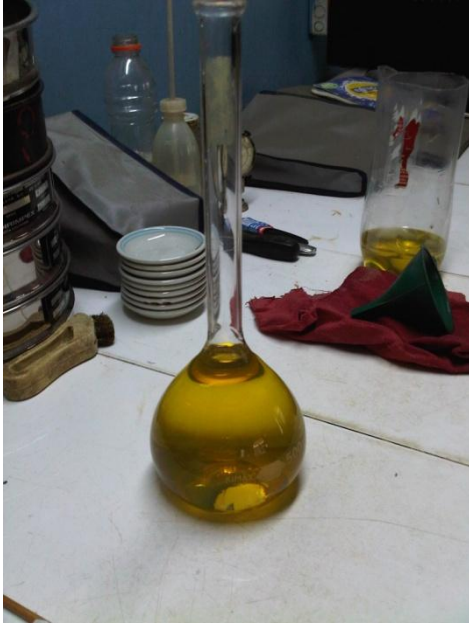
Figura 10. Balón volumétrico graduado de 500 cc con ACPM para la realización del ensayo de densidad del cemento.
