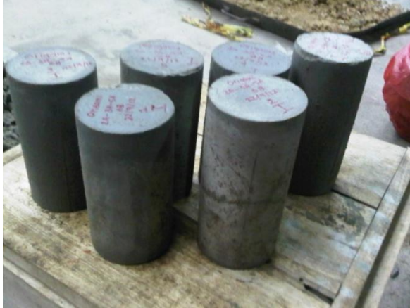
Figura 6. Cilindros de lechada con aditivo de \varnothing : 7.5 cm y h: 15 cm aproximadamente
