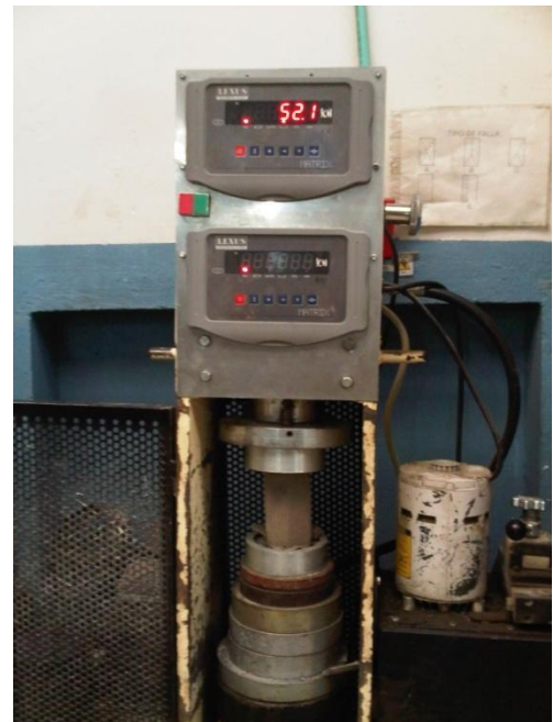
Figura 9. Ensayo de resistencia a la compresión en cilindros.
