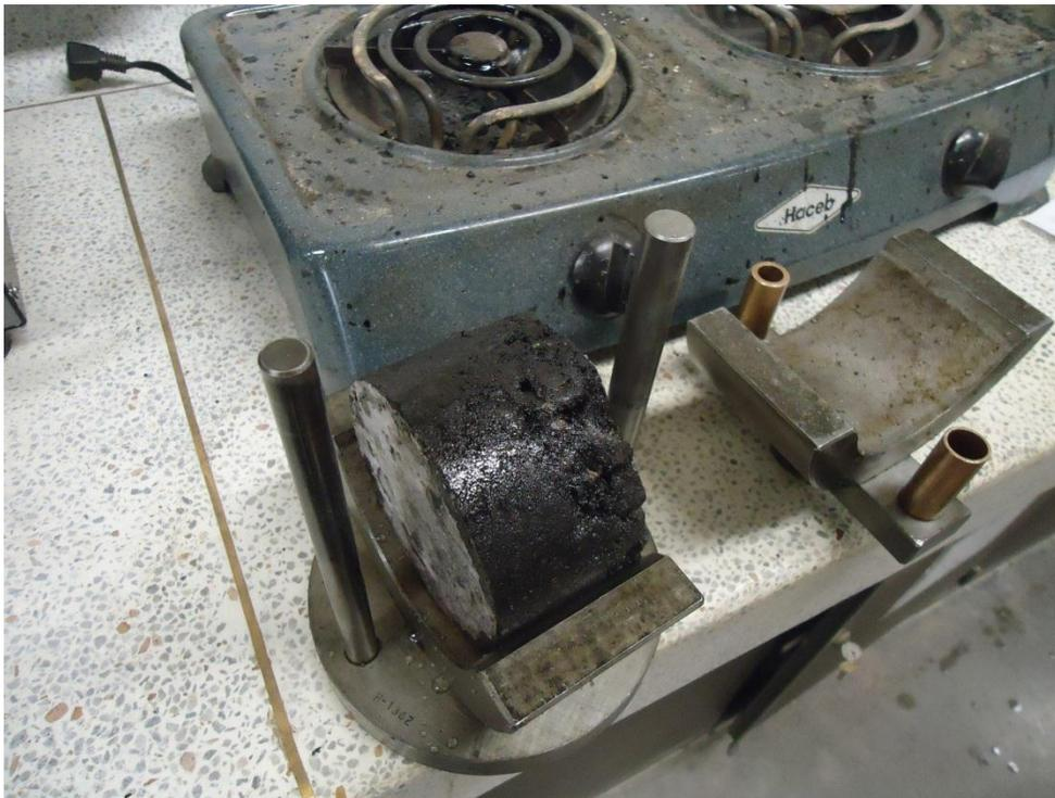
**Armar la armadura para ensayo de briquetas.**
