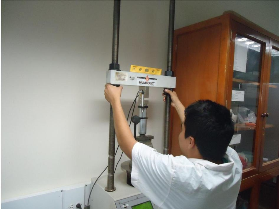
**Montaje ensayo de resistencia mecánica por el método Marshall.**
