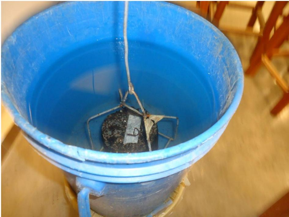
**Sumergimiento de briqueta para ensayo de densidad bulk.**
