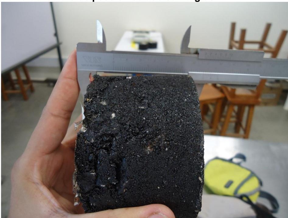
**Toma de medidas de altura de probetas.**
