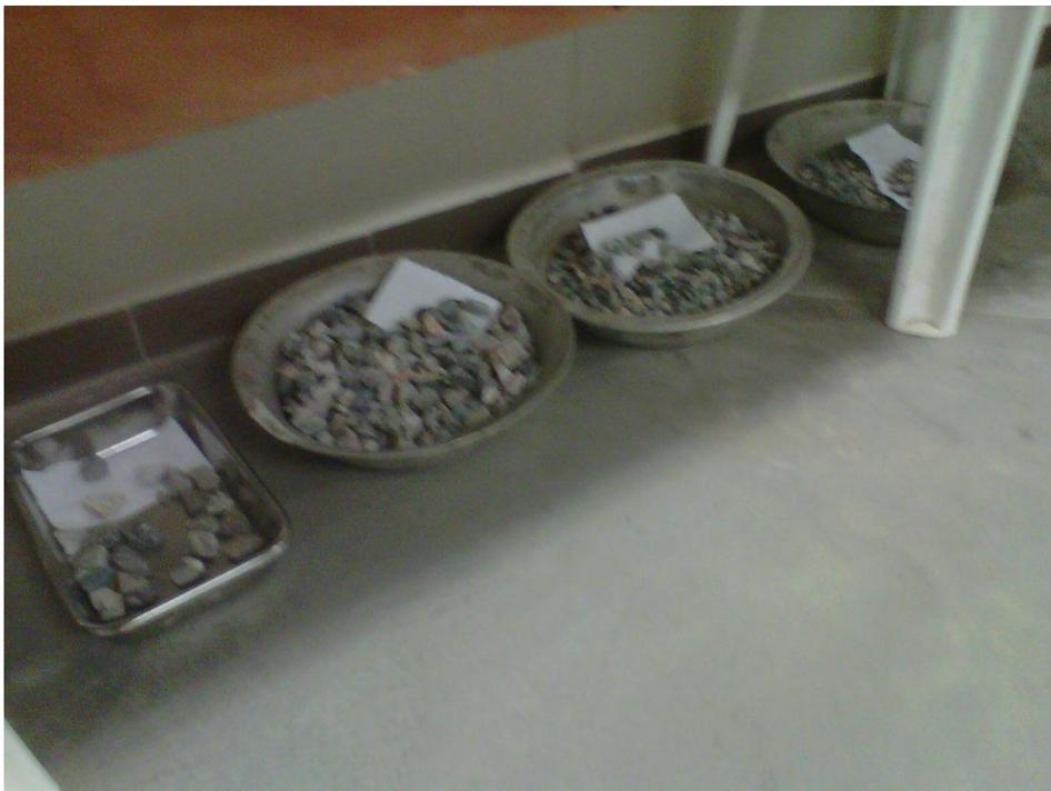
**Agregados separadas por fracciones.**
