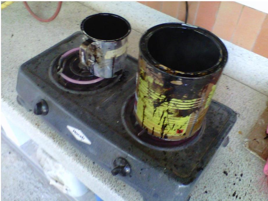
**Calentar el asfalto hasta llegar a una temperatura superior al punto de ablandamiento.**
