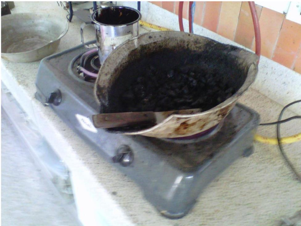
**Mezcla en caliente de los agregados de la MDC-2.**
