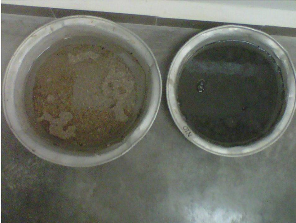
**Muestra humedad de arena y ceniza para ensayo de gravedad específica.**
