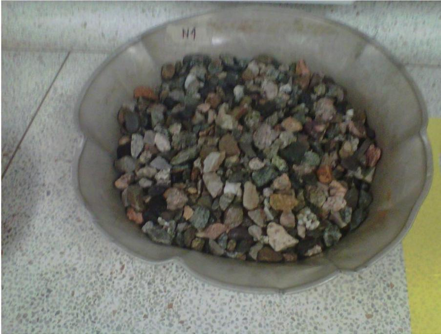
**Muestra humedad de agregados gruesos para ensayo de gravedad específica.**
