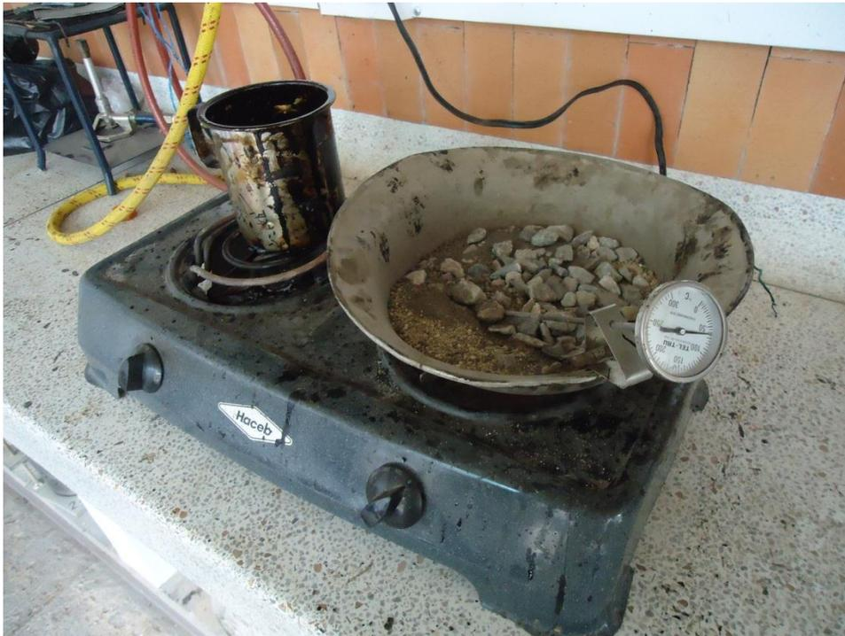
**Calentamiento de agregados hasta llegar a una temperatura superior a 150°C.**
