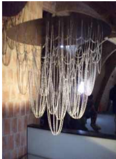
Fig. 1. Experimentación de Gaudí con el form-finding , para el diseño de La Sagrada Familia. Tomado de: shorturl.at/tMU78 , el: 22/06/2019
