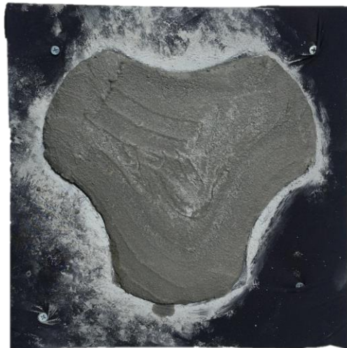
Fig. 36. Encofrado elástico, tela licra ensamblada con tornillos al MDF.
