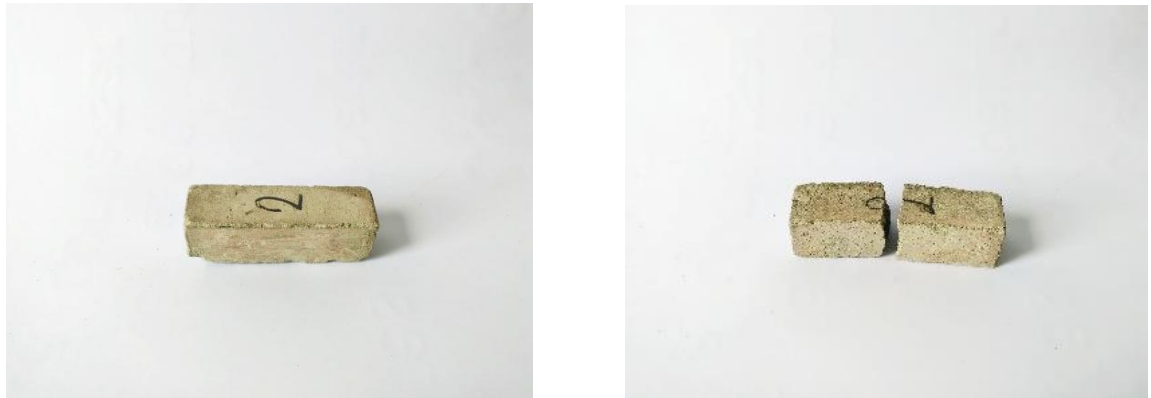
Fig 22-23. Probetas de concreto con la mezcla y proporciones 1:2:2 para el analisis de las propiedades mecánicas.(rectangulares). Elaboración propia.
