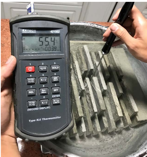
Imagen 22 - proceso de envejecimiento a 55 C
