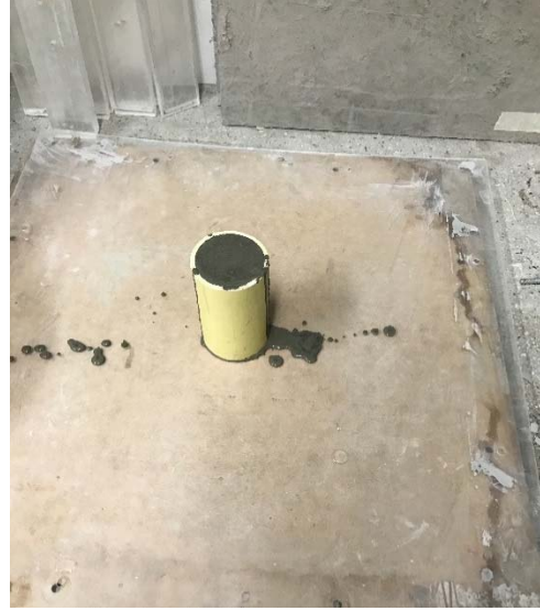
Imagen 14 - Muestra 2. 30 segundos de espera previo a retirar el tubo
