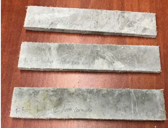
Imagen 38 - probetas fibra de fique + hidrofóbico 14 días + 6 horas
