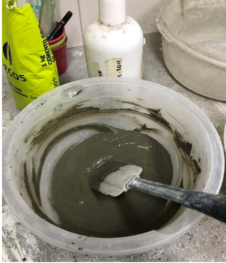
Imagen 11 - muestra 1 (plastificante naftaleno superplastificante de la marca Superaplica)
