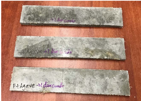
Imagen 32 - probetas fibra de fique + agave 14 días + 2 horas
