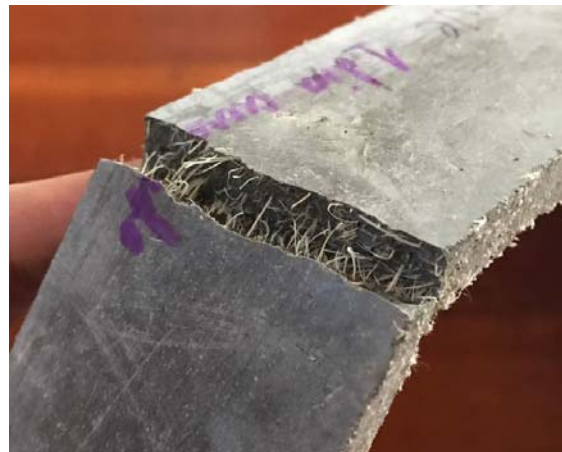
Imagen 33 - fisura expuesta a exceso de carga
