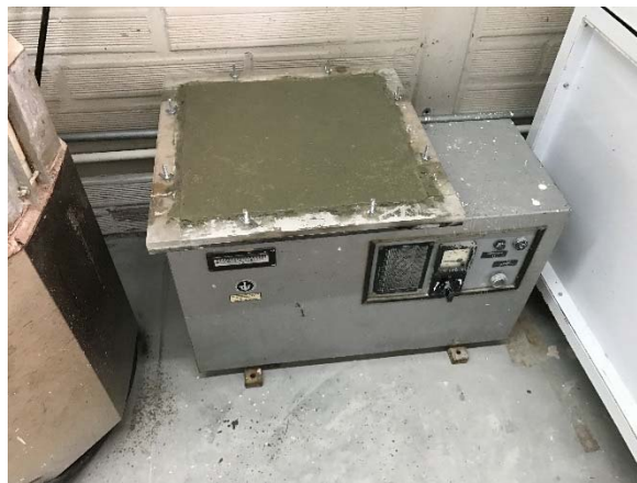
Imagen 7 - máquina de vibrado
