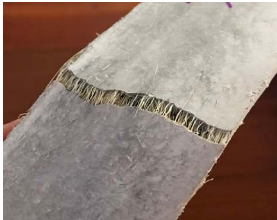
Imagen 39 - fisura expuesta a exceso de carga
