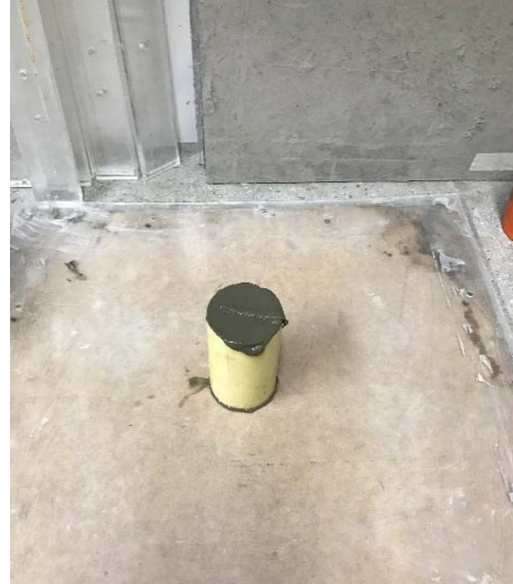
Imagen 10 -Muestra 1 - 30 segundos de espera previo a retirar el tubo
