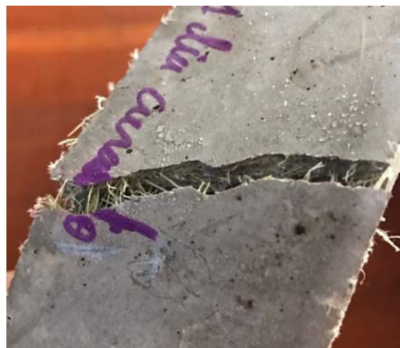
Imagen 36 - fisura expuesta a exceso de carga
