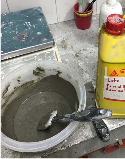
Imagen 13 - Muestra 2 (plastificante plastificante sika plast rm 100)
