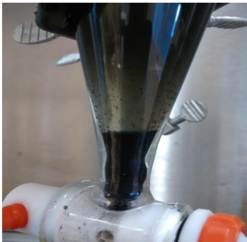
**Figura 21.** Embudo de separación con material de grafito exfoliado.
