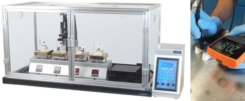
**Figura 24.** Equipo de inmersión controlada o DipCoatig utilizado es un sistema de recubrimiento SILAR con agitador magnético Modelo: HO-TH-03B (Imagen izquierda), y el medidor de espesor de recubrimiento Elcometer 500 Medidor (Imagen derecha).
