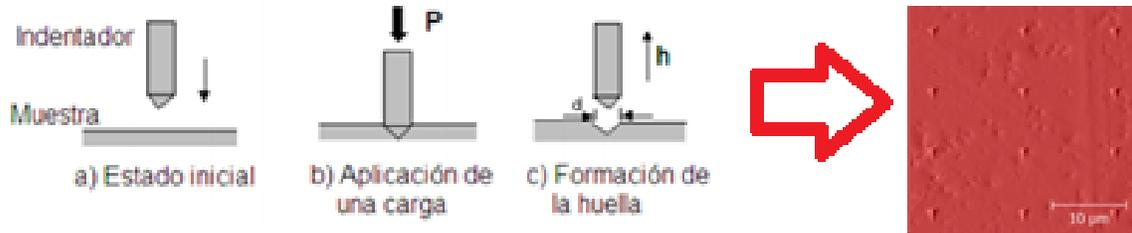
**Figura 37.** Prueba de nanoindentación. La prueba consiste en 3 etapas, las cuales consisten en a) preparar la muestra, b) aplicación de una carga sobre la muestra, c) retiro de la carga y formación de huella y por último se repite el procedimiento de manera aleatoria y varias veces para asegurar valores estadísticamente válidos. Imagen tomada y modificada de <https://www.icmm.csic.es/fis/espa/nanoindentacion1.html>.
