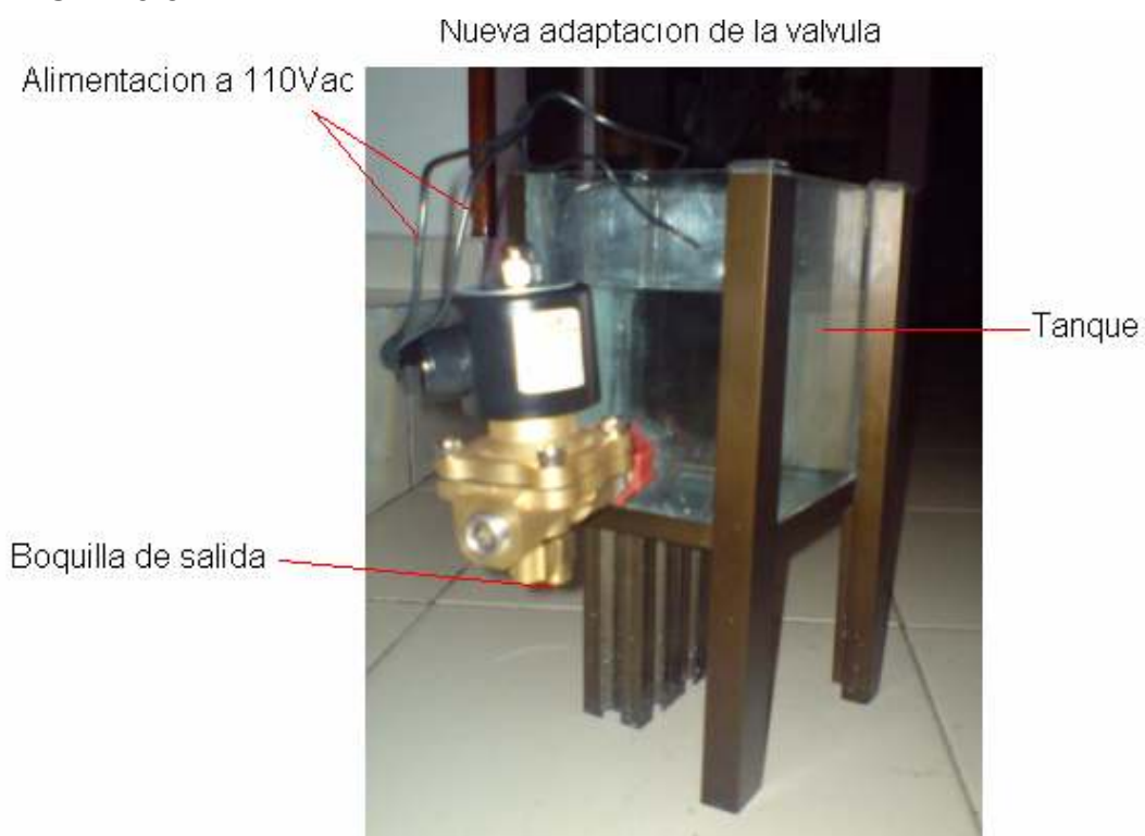
Figura 21. Electovalvula con tanque.
