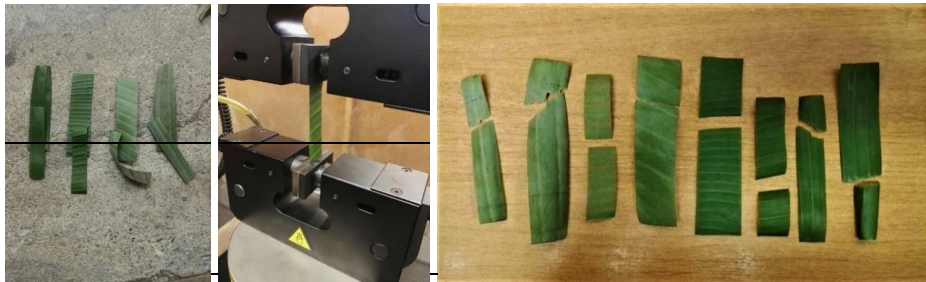
Figura 1: Probetas antes, durante y después de las pruebas de resistencia a la tracción.
