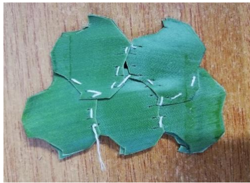
Figura 14. Lámina 1 después de ser fallada en las pruebas de tracción en la máquina INSTRON, evidencia de los puntos de ruptura de las fibras.
