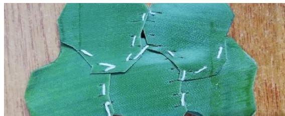
Figura 8. Lámina 1 después de ser fallada en las pruebas de tracción en la máquina INSTRON, evidencia de los puntos de ruptura de las fibras.
