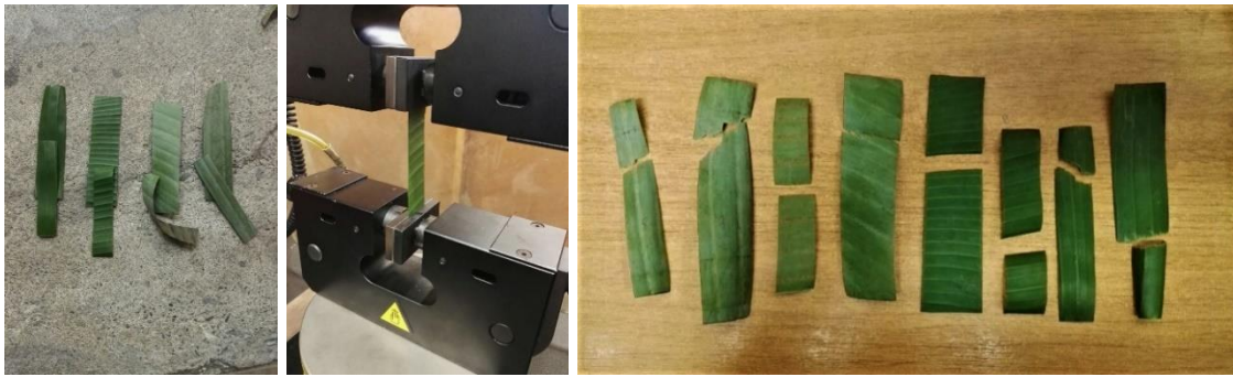
Figura 6. Probetas antes, durante y después de las pruebas de resistencia a la tracción.
