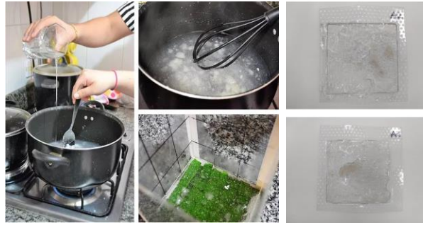
Figura 7. Proceso de creación de película de aditivo a base de almidón de yuca.
