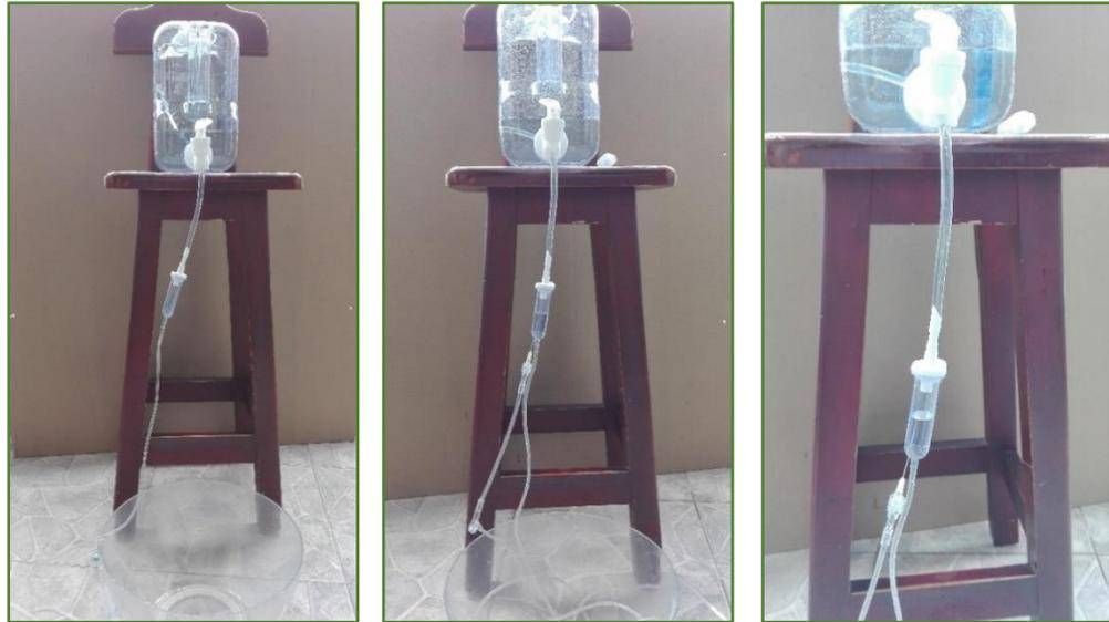
Figura 29. Experimento para verificar el caudal de agua por minuto. Elaboración propia
