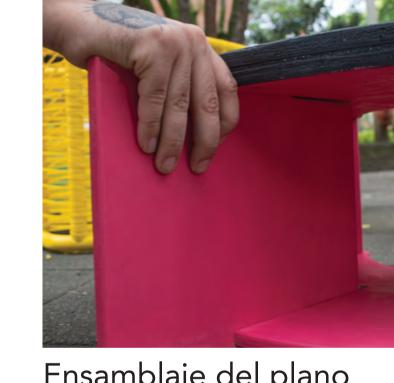
Ensamblaje del plano longitudinal en la ranura.
