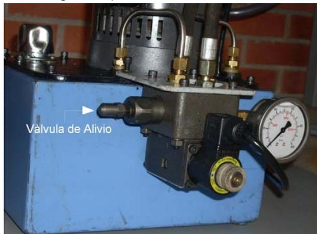
Figura 30: Válvula de Alivio Acoplada al Sistema Hidráulico [17]
