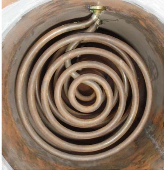
Figura 35: Resistencias Eléctricas de Calentamiento [2]
