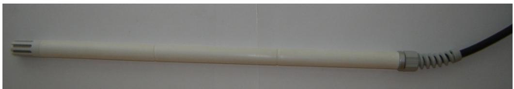
Figura 53: Sonda del HD2007TC/2/5 [17]
