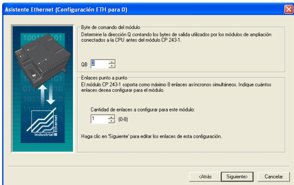
Figura 117: Byte de Comando y Enlaces en el Asistente Ethernet [17]
