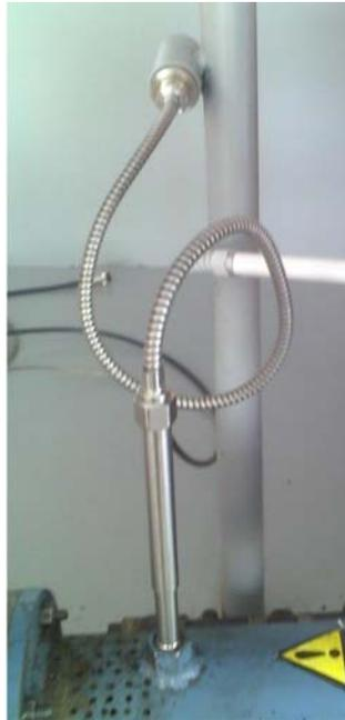
Figura 41: Transmisor de Humedad Instalado en la Cilindro de Extracción [17]
