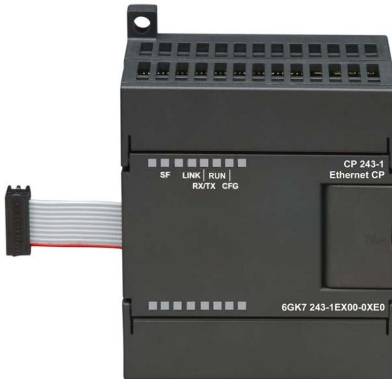
Fig. 3. Frontal del equipo con indicadores LED
