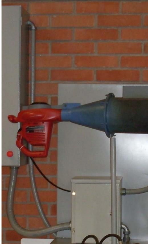
Figura 151: Conexión del Sistema de Calentamiento [17]
