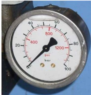
Figura 29: Manómetro del Sistema Hidráulico [17]
