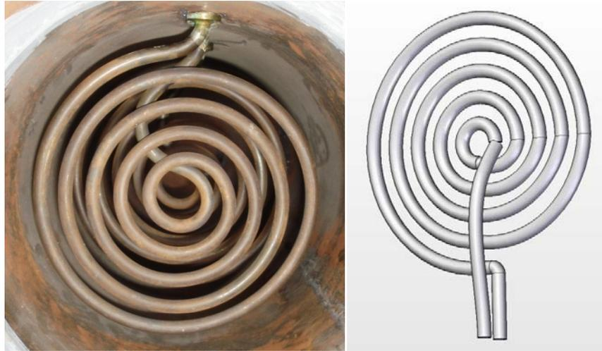
Figura 62: Resistencia de Calentamiento [17]
