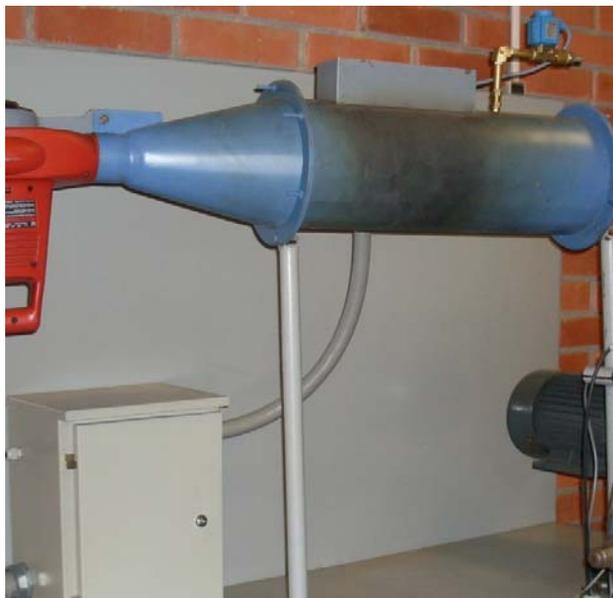
Figura 150: Conexión del Sistema de Calentamiento [17]
