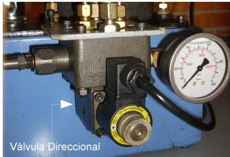
Figura 31: Válvula Direccional Acoplada al Sistema Hidráulico [17]
