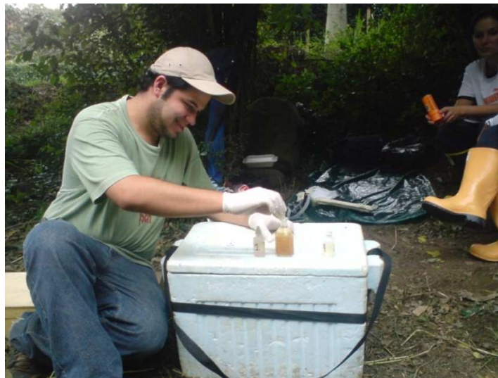
Figura 10. Prueba de Oxígeno Disuelto in situ
