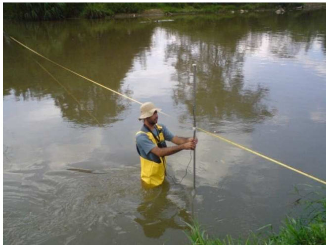
Figura 14. Aforo con Molinete
