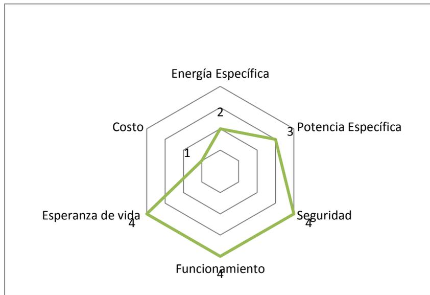
*Figura 13. Relación entre las características relevantes para las baterías de litio titanato, modificado de [44]*
