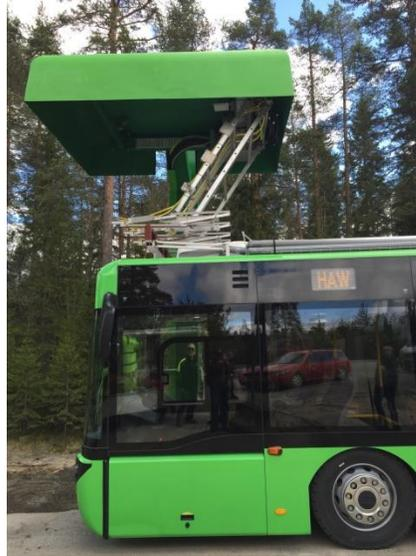
Figura 15. Autobús eléctrico Hybricon y sistema de barra deslizante Opbrid [50].
