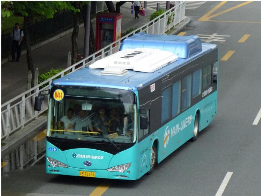
Figura 11. Bus con batería a bordo de la ciudad de Shenzhen [41]
