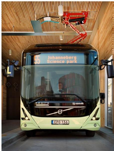
*Figura 17. Autobús híbrido de Volvo y sistema de carga de pantógrafo deslizante de Opbrid en Gotemburgo [52].*
