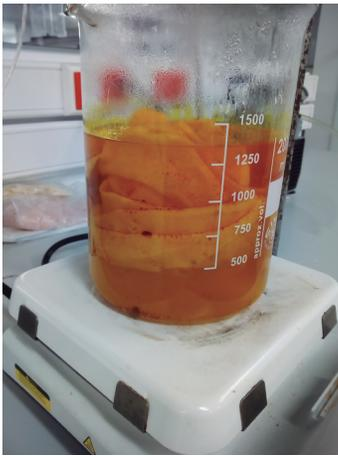
Figura 49. Teñido colorante sin disolver. Imagen propia
