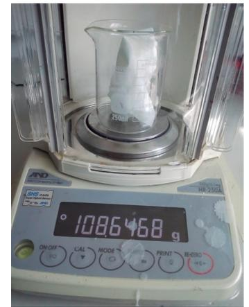
Figura 21. Muestra de 10x 10 en la balanza. Imagen propia
