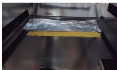
Figura 69. Muestras en la máquina de solidez a la luz. Imágen propia.
