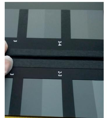
El test de solidez a la luz se realiza con luz de xenon, El ciclo elegido para realizar este test fue la opción cuatro de la norma que es para climas templados tiene una duración de 120 min, exposición a la luz de 102 min solamente,  $50 \pm 5\%$  de humedad relativa, alternando con 18 minutos de luz y agua pulverizada, temperatura del panel negro  $63 \pm 3^\circ \text{C}$ .
