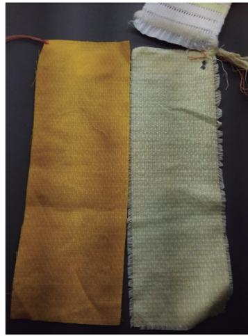
Figura 65. Cambio de color después del lavado. Imagen propia
