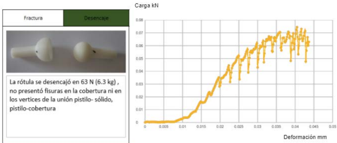
Figura 49: Análisis y gráfica ensayo de tracción rótula 17 mm con 66 % de cobertura.
