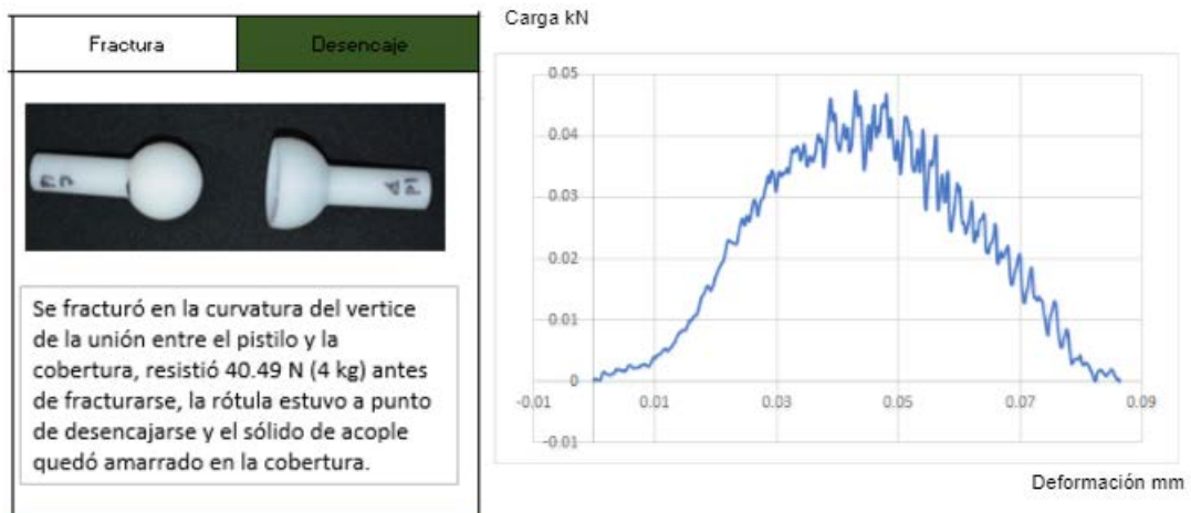
Figura 44 : Análisis y gráfica ensayo de tracción rótula 25 mm con 66 % de cobertura.
