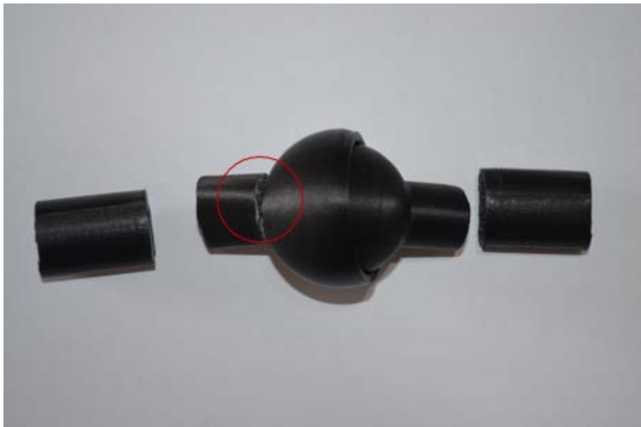
Figura 36: Prueba preliminar, fallo en el vértice (concentrador de esfuerzos)
