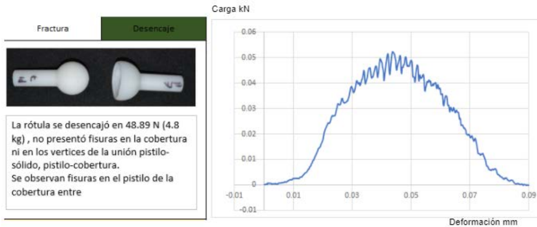
Figura 47 : Análisis y gráfica ensayo de tracción rótula 21 mm con 60 % de cobertura.
