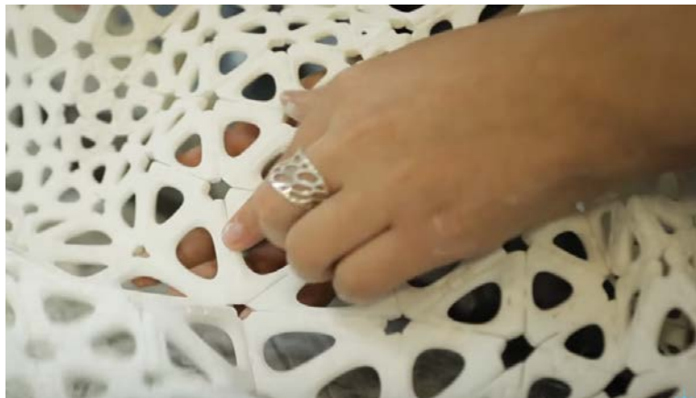
Figura 5. Vestido impreso en 3d. Ejemplo de mecanismos integrales hechos con tecnologías 3d. Recuperado de: https://www.youtube.com/watch?v=wdRswasftfI
