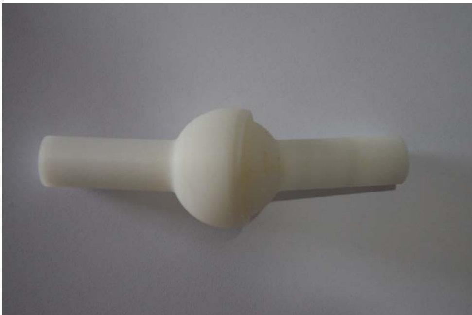
Figura 35 : Rótula de 30 mm de diámetro en el sólido de acople y 15 mm de diámetro de pistilo.
