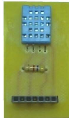
Figura 17. Módulo Humedad y Temperatura
