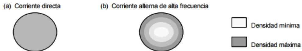
**Figura 13. Densidades de corriente en un mismo conductor a corriente de alta frecuencia**
