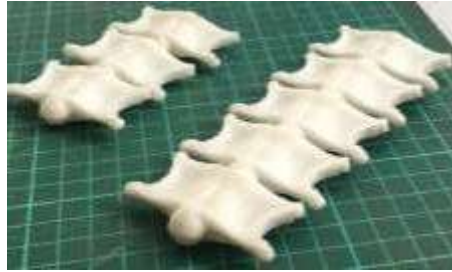
Figura 10. Primera prueba impresa; probeta de material TPU, material de impresión tipo elastómero. Fuente: Autoría propia
