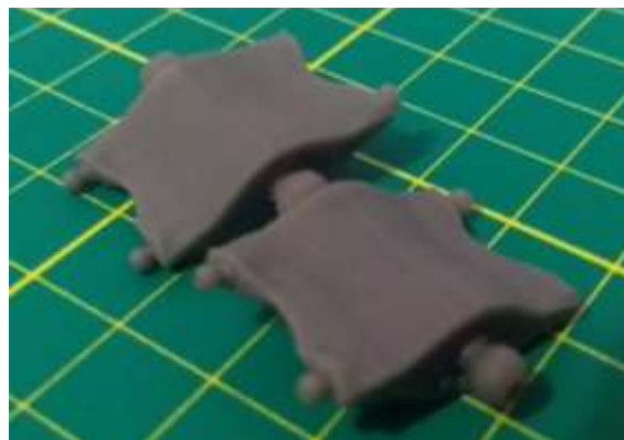
Figura 12. Módulos impresos por rayos UV a pequeña escala, dimensiones: 2 cm X 2 cm. Fuente: Autoría propia
