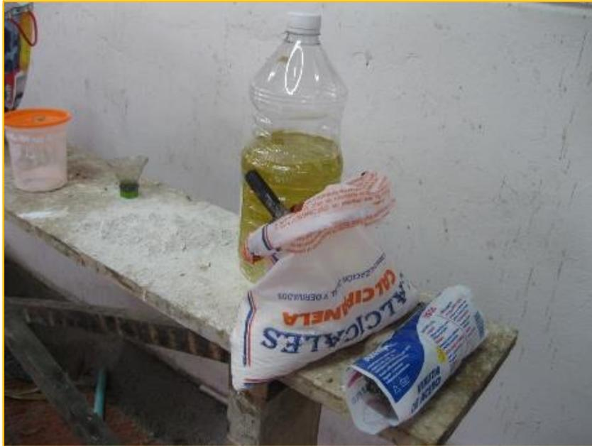
Ilustración 28. La cal: se le agrega a la cocha para afinar y limpiar cuando la cocha no quiere dar punto.
