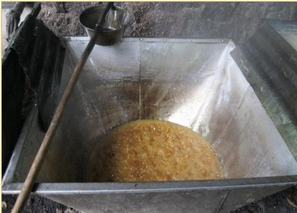
Ilustración 45. Después de evaporarse el agua de los jugos de la caña, el dulce o la denominada “cocha” se pone espesa y es allí donde empieza el cateo del punto de la panela. Fuente: Katerine Grajales, 2015.
