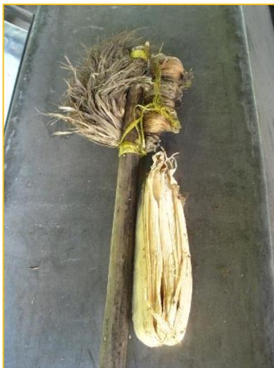
Ilustración 18. Hisopo. Es un limpiador para la línea de cachaza que se hace en el borde de los fondos y calderas a medida que se evaporan los jugos de la caña en la cocción. Es hecho con la cáscara seca de la mazorca de maíz. Fuente: Katerine Grajales, 2014.
