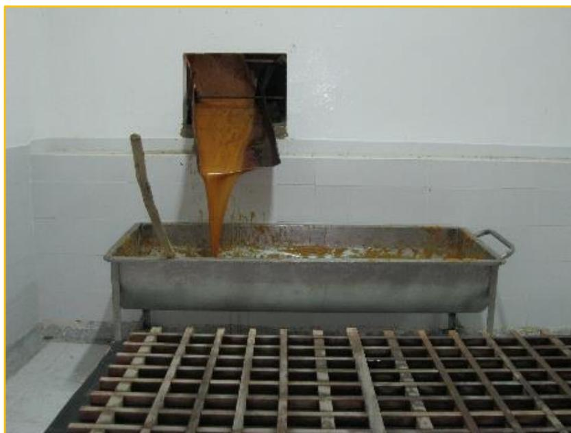
Ilustración 47. Después de que la panela ha cogido su punto, se vierte en la tacha la mezcla para batirla retirada del fuego. Fuente: Katerine Grajales, 2015.
