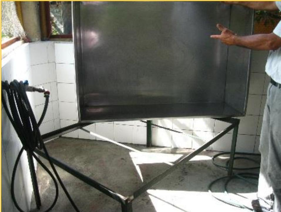
Ilustración 10. Tanque de agua para lavar las gabereras. Está hecho en material de acero inoxidable. Fuente: Katerine Grajales, 2014.
