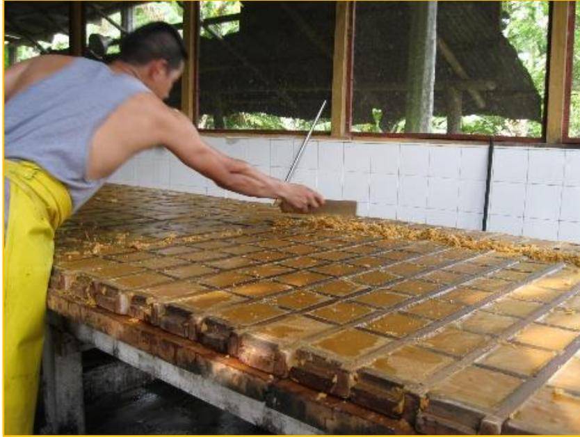
Ilustración 50. Con una espátula de madera se limpian los bordes de las gabereras para hacer que salga con un mejor molde la panela. Los pequeños residuos producto de esta limpieza son vertidos en la tacha para mezclarse con la siguiente mezcla de dulce caliente que se vaya a batir, para no desperdiciar panela.
