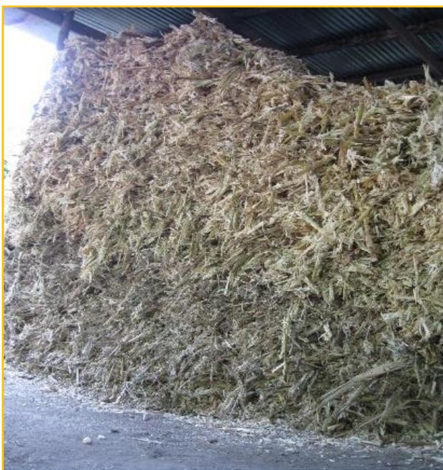
Ilustración 24. La bagacera. Es el lugar donde se va acumulando el bagazo de cada molienda para que se seque y sirve en las próximas moliendas como material de combustión en la hornilla. Fuente: Katerine Grajales, 2014.
