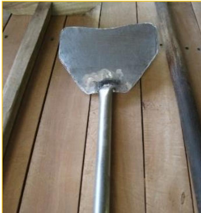
Ilustración 14. Instrumento en acero inoxidable utilizado para batir la panela en la tacha. Fuente: Katerine Grajales, 2014.
