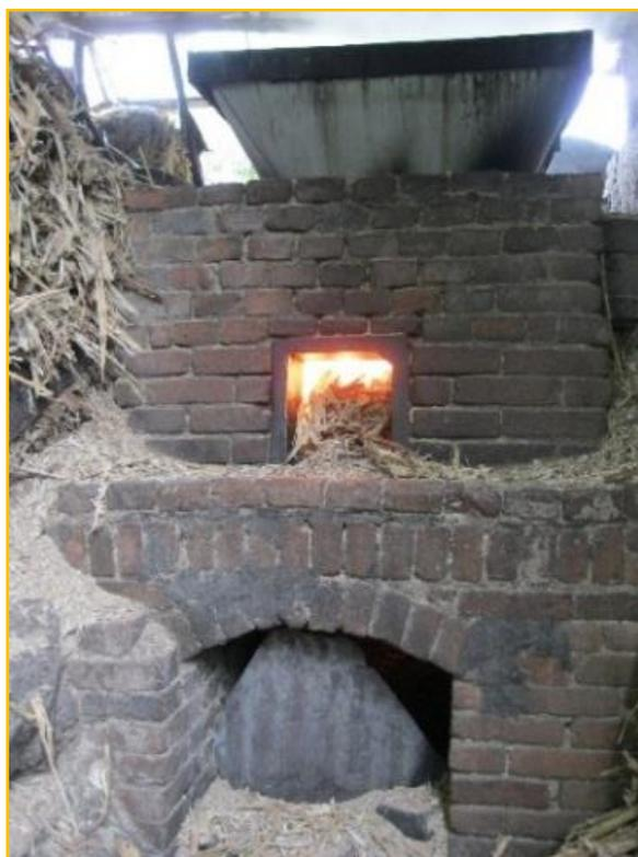
Ilustración 25. La hornilla. Es hecha con adobes y está localizada por debajo de las calderas y fondos. La hornilla funciona por medio de la combustión del bagazo que se acumula en cada molienda. Fuente: Katerine Grajales, 2014.
