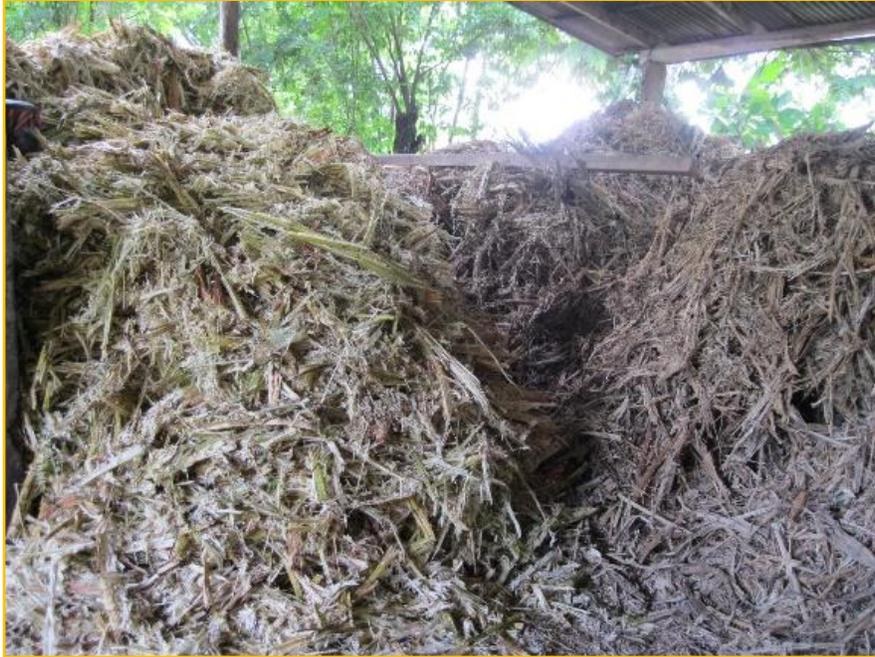
Ilustración 32. Bagazo: sirve como material de combustión en la hornilla. Resulta de la moler la caña en el trapiche. Fuente: Katerine Grajales, 2014.
