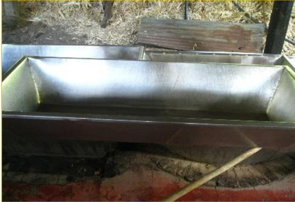
Ilustración 9. La tacha. Es donde se deposita el dulce de panela hirviendo y se bate para darle un punto más refinado por fuera de la hornilla. Fuente: Katerine Grajales, 2014.
