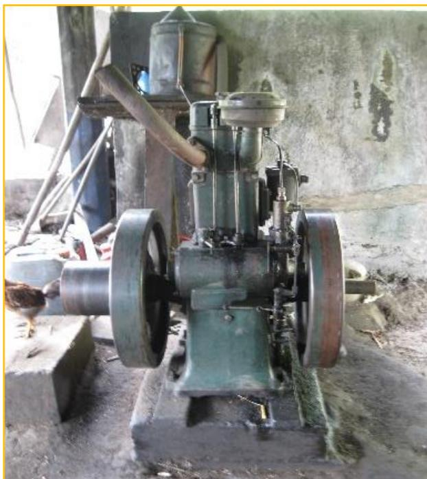
Ilustración 23. El motor que mueve los trapiches. El combustible utilizado es el Diesel. Fuente: Katerine Grajales, 2014.
