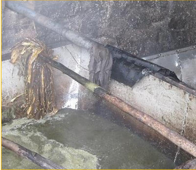
Ilustración 19. Matacho hecho con las cortezas del guáximo para limpiar los jugos de la caña. Tiene forma de traperera. Fuente: Katerine Grajales, 2014.
