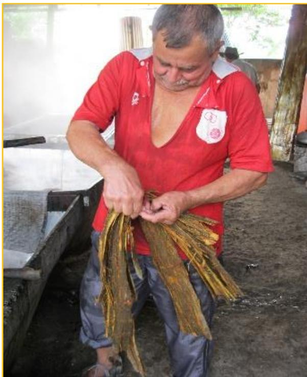
Ilustración 40. Elaboración del trapero de guácimo para revolver los jugos de la caña y hacer que todos los residuos sólidos salgan a flote y se puedan sacar. Fuente: Katerine Grajales, 2015.
