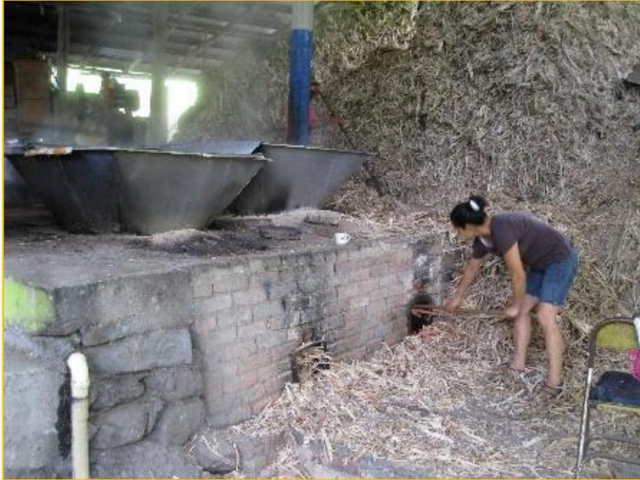
Ilustración 38. Hornero. Persona que se encarga de meter bagazo seco y leña a la hornilla para matener la temperatura de la hornilla. Fuente: Katerine Grajales, 2015.
