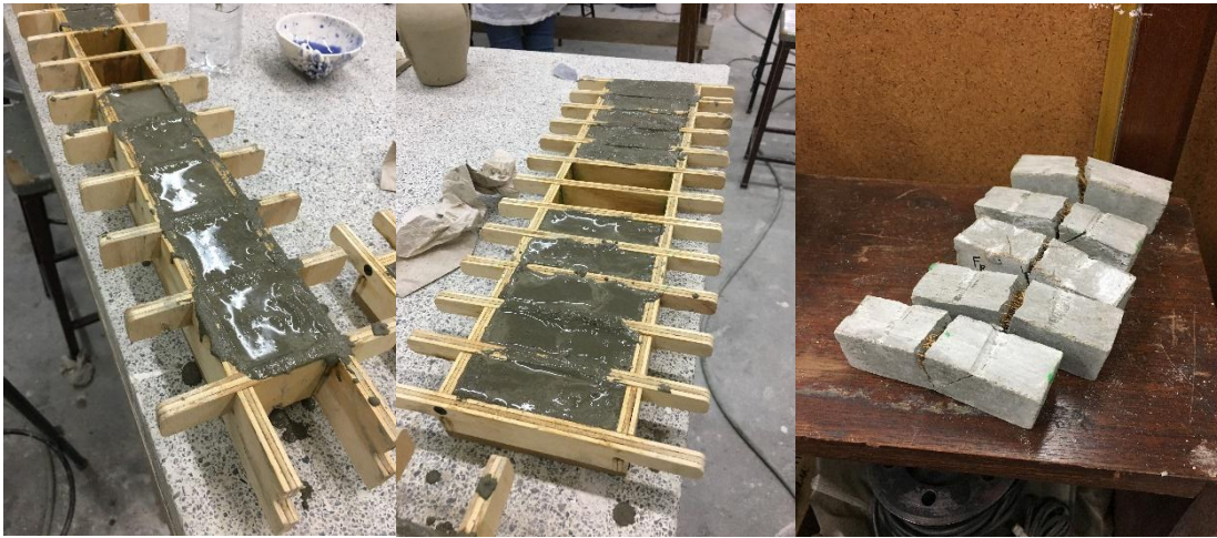
Serie de probetas con concreto, fibra de coco y óxido de hierro
