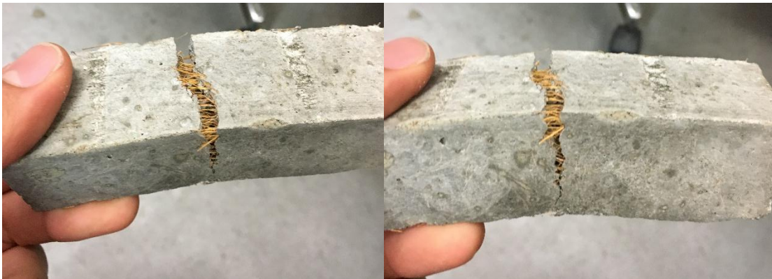
Figura 10. Fisura de las probetas de flexión. Se puede observar como las probetas siguen unidas por medio de las fibras.
