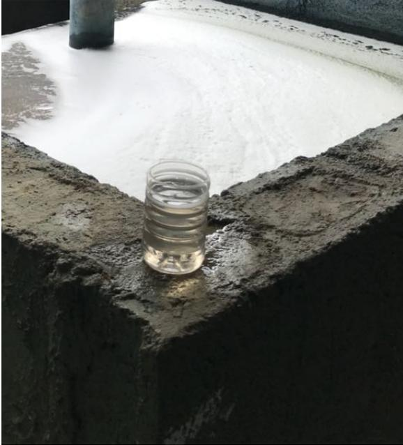
*Ilustración 31 Fotografía. Muestra de agua después del proceso de decoloración.*
