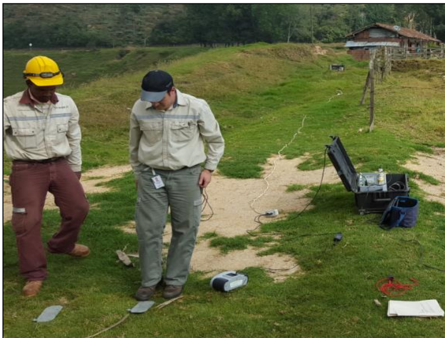
Figura 52. Medida tensión de paso
